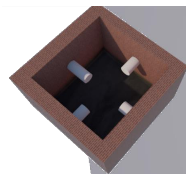
Caja de inspección
