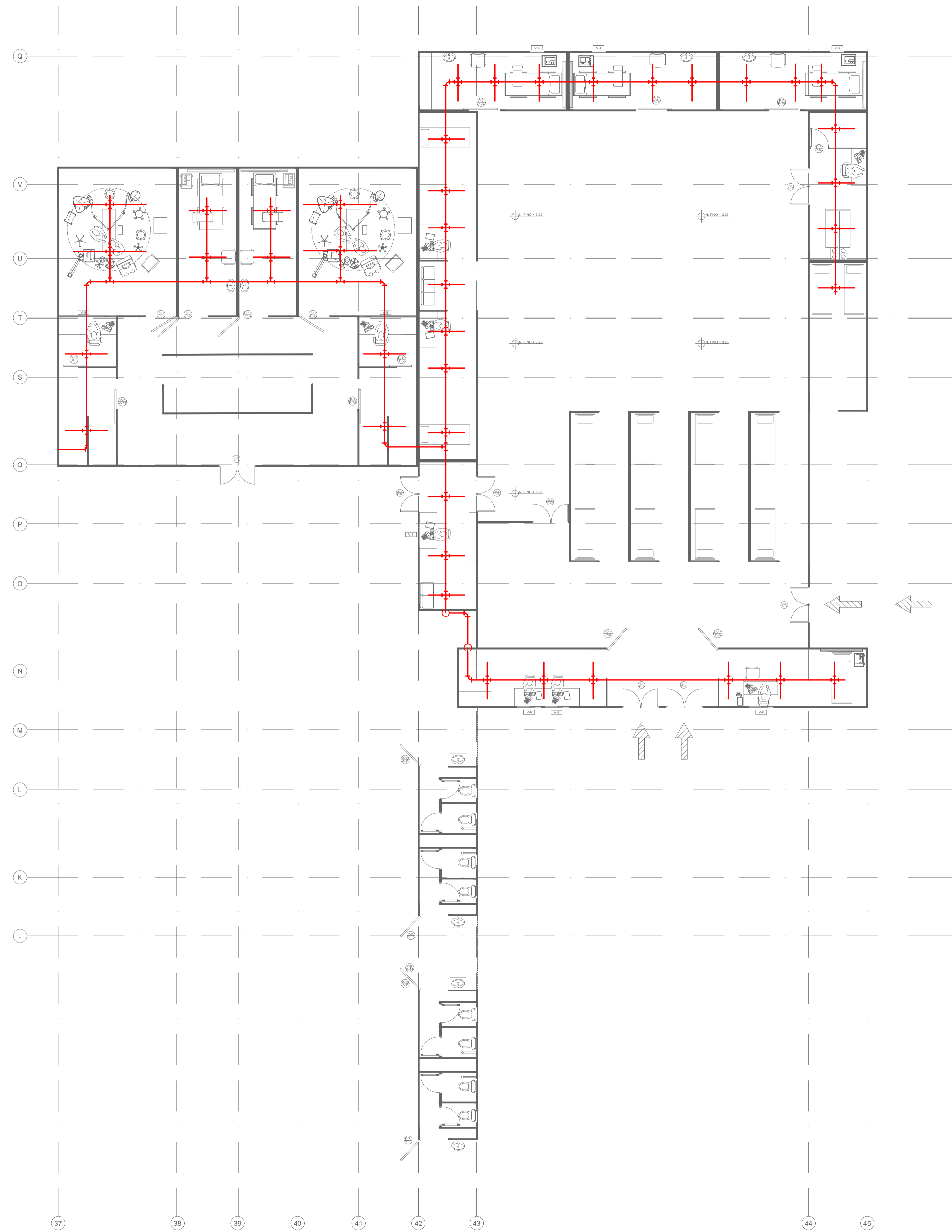
A Planta Instalaciones Red Contra Incendios ESC 1:100
