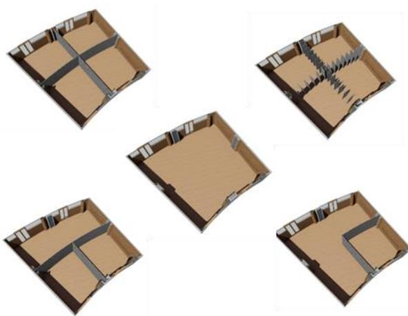
*Nota.* La siguiente figura representa el sistema de guardado de los muros móviles de los espacios flexibles y adaptables. Elaboración propia.
