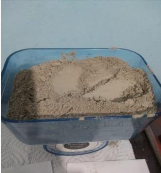
Figura 17, 18 y 19. Arena de río , grava. Dosificación por peso de cemento Portland tipo .
