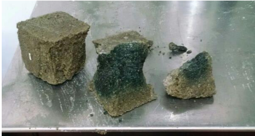
Ilustración 11: Morteros de hidróxido de sodio después de la falla
