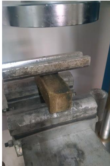
Ilustración 15: Falla de morteros a flexión
