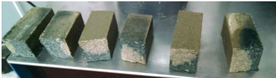
Ilustración 16: Probetas de flexión después de la falla
