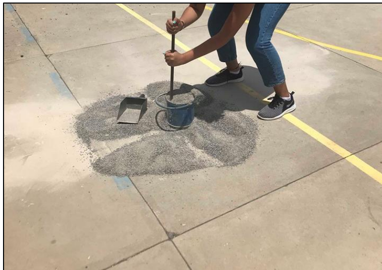
Foto 5. Realización de los 25 golpes correspondientes según prueba peso volumétrico seco varillado.
