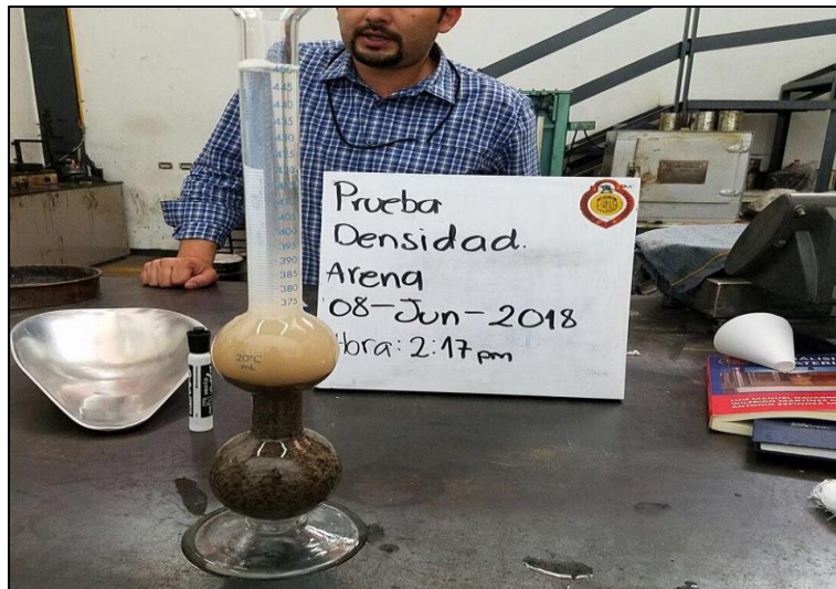
Foto 14. Prueba de densidad al material fino.
