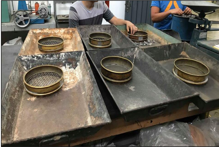
Foto 21. Prueba de granulometría para material grava triturada.
