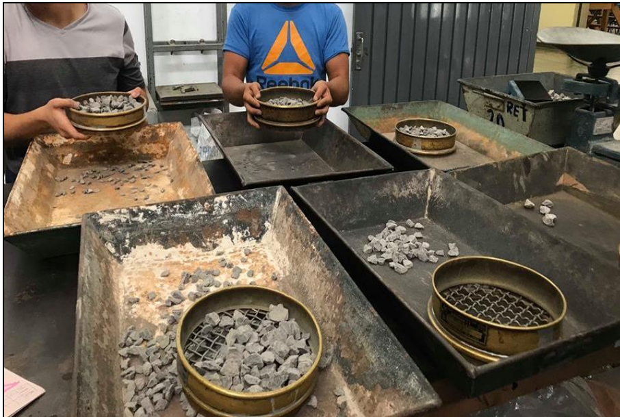
Foto 22. Prueba de granulometría para material grava triturada.
