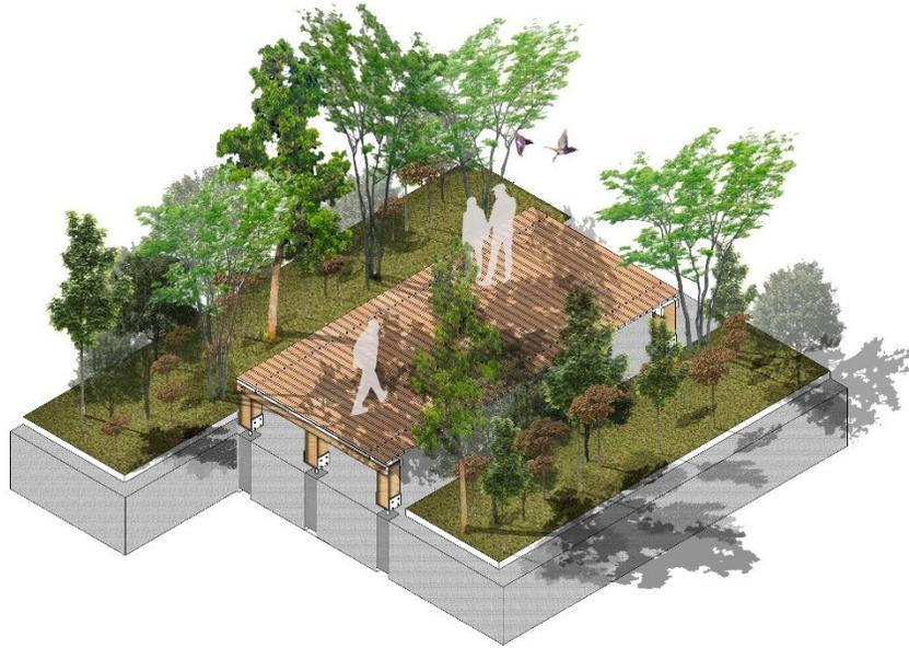
*Nota: Trayectorias internas del humedal. Las circulaciones aisladas del terreno y elaboradas en una madera inmunizada oriunda de la región, son las disposiciones constructivas que plantea el plan de manejo ambiental, dentro del terreno normativo que pertenece a esta jurisdicción. Elaboración propia.*
