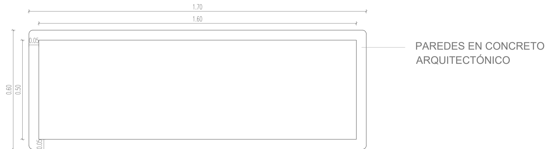
D19 BANCA EN CONCRETO - PLANTA ESCALA 1:10
