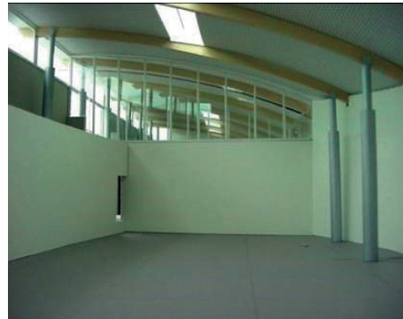
Figura 5. Cielo artificial: maqueta con visualización de nivel lumínico, calidad y distribución de luz.
