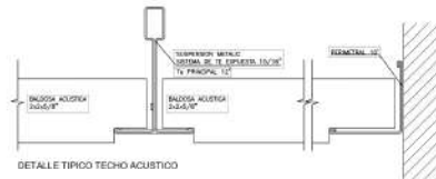
29 DETALLE TIPICO TECHO ACUSTICO ESCALA 1: 20
