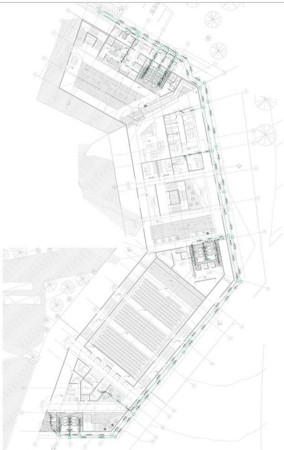
S RED SANITARIA 1er PISO ESCALA 1: 300
