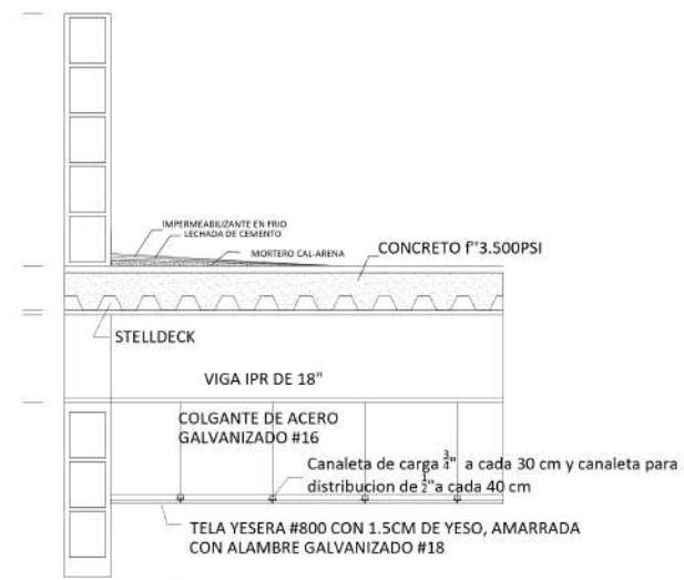
6 DETALLE EMPALME PLACA Y CIELO RASO ESCALA 1: 10
