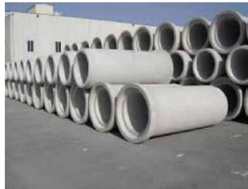
Red troncal 1.40 m en concreto reforzado
