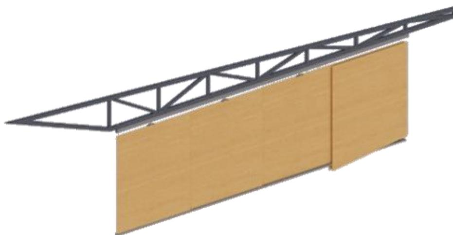
*Figura 50.* Isométrico muro corredizo.
