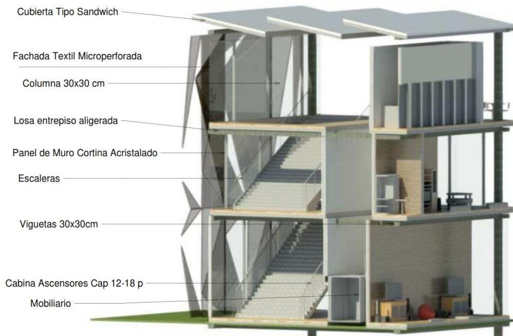
Figura 32. Corte Fachada Constructivo.
