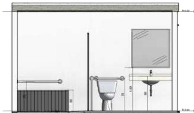
*Figura 45* Corte de baño, opción 3. Mediante el estudio de antropometría y ergonómica de las personas, se determinó las alturas accesibles de las personas con discapacidad física para su alcance y correcto funcionamiento de los elementos que se instalan en el baño, elaboración propia.
