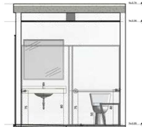
*Figura 40* Planta de baño, opción 1. En el diseño del baño se referencia el acceso total y seguro de una persona con discapacidad física, teniendo los espacios de rotación y maniobra acordes a las necesidades de la persona, con una ducha funcional y adaptada para el ingreso de un tipo de silla de ruedas, elaboración propia.
