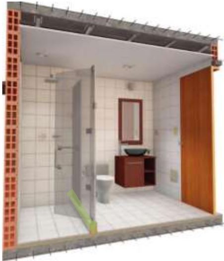
*Figura 28* Ilustración de baño convencional, con eliminación del poyo de la ducha. Tomado de “Baños Área 2,45 x 1,60 m detallados generales construdata” Saéz, F, 2017. Recuperado de <https://docplayer.es/63395481-Banos-area-2-45-x-1-60-m-detallados-generales-construdata.html>
