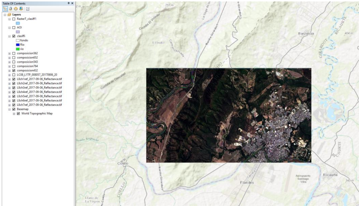
Gráfica 33: Identificación del río Magdalena y Girardot a partir de la creación de bandas espectrales en un mapa por teledetección. El mapa realizado por Tatiana Yara (2018) permitió localizar una imagen satelital a través de la aplicación de una base topográfica de mapa, la realización de firmas espectrales evidenció la cuenca del río Magdalena y la conjugación en bandas espectrales la ciudad de Girardot.
