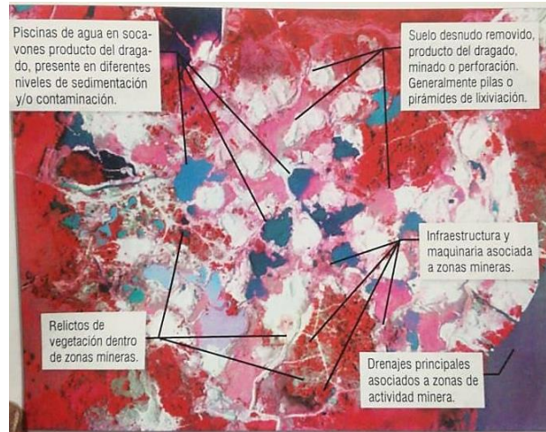
Gráfica 16: Ejemplo de teledetección. Imagen satelital del Municipio de Cauca para el monitoreo de zonas mineras. Por medio de este tipo de representación se puede enseñar las problemáticas de la degradación del suelo en territorios de alta biodiversidad (CIAF, 2017).
