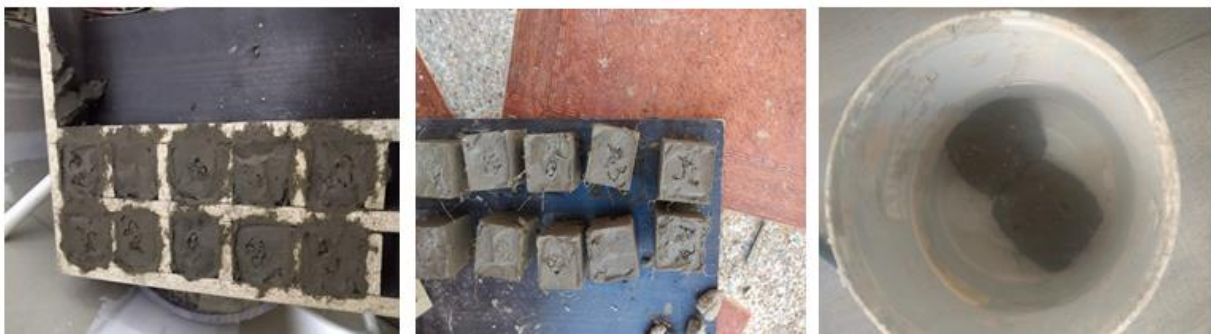
Figura 21. Proceso de fraguado y desencofre de los testigos de morteros. Elaboración propia
