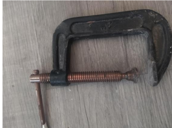
Figura 20. Prensa manual para realizar las pruebas de compresión. Elaboración propia
