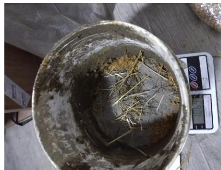
Figura 19. Mezcla de Esterillas de paja con dosificación a 1/4. Elaboración propia.
