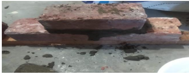
Figura 3. Primera muestra de pega de mampostería estructural. Elaboración propia.
