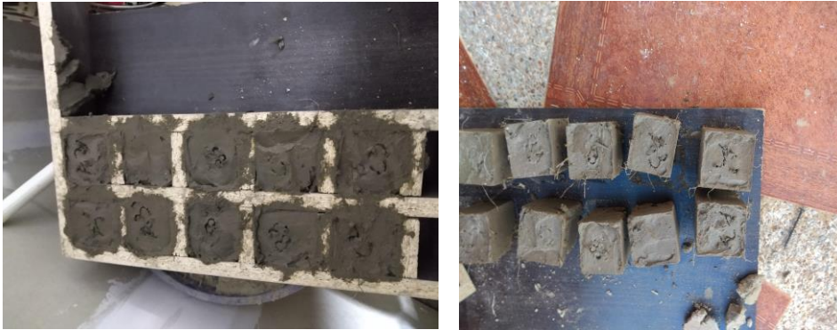
Figura 8. Encofrado de muestras de ensayo a compresión. Elaboración propia
