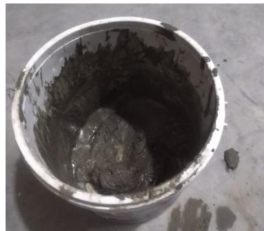
Figura 12. Mezcla de pega de mampostería estructural con fibra de fique. Elaboración propia
