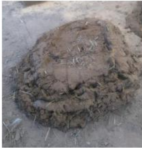
Figura 36 Mezcla Mezcla para la elaboración de los adobes. Elaboración propia.
