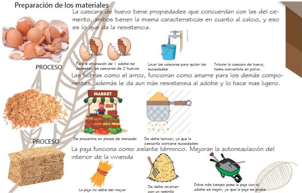
Figura 33 Proceso de inspección. Se explica como ordenar los materiales antes de ser agregados a la mezcla. Ver manual página 6. Elaboración propia
