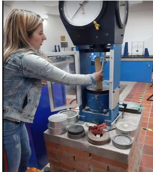
Figura 42Primera prueba, primer prototipo. El primer prototipo que no cumplía con las medidas ni la resistencia adecuada. Elaboración propia
