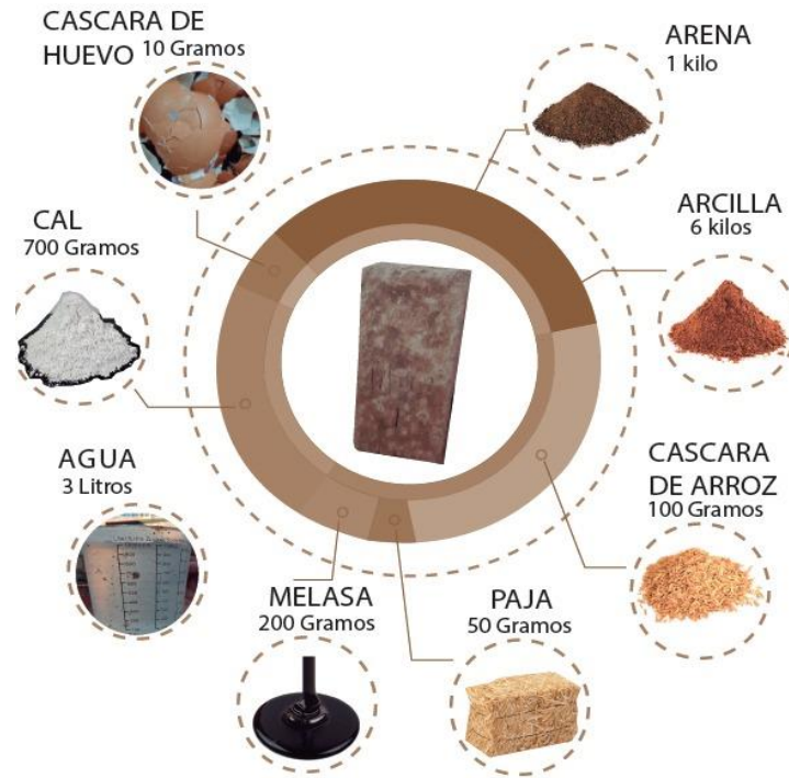
Figura 34 Porcentaje adobe final Se observa los ingredientes finales, con sus respectivas cantidades. Elaboración propia.
