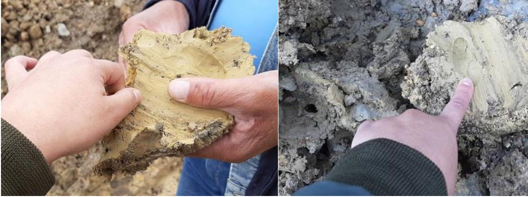
Figura 21 Perforación de terreno a 80 cm. cómo se observa, se extrae arcilla del lugar para hacer pruebas. Elaboración propia.
