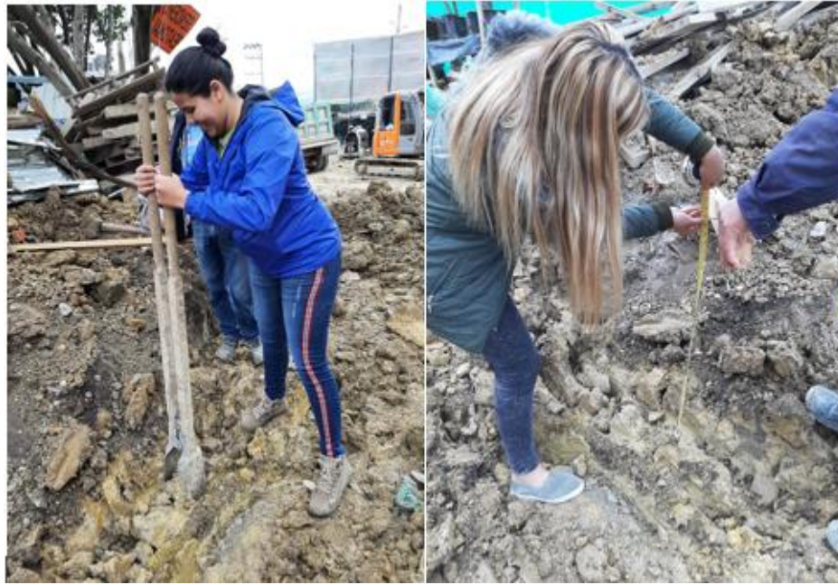
Figura 19 Perforación del suelo de Usme. cómo se observa, se extrae arcilla del lugar para hacer pruebas. Elaboración propia.
