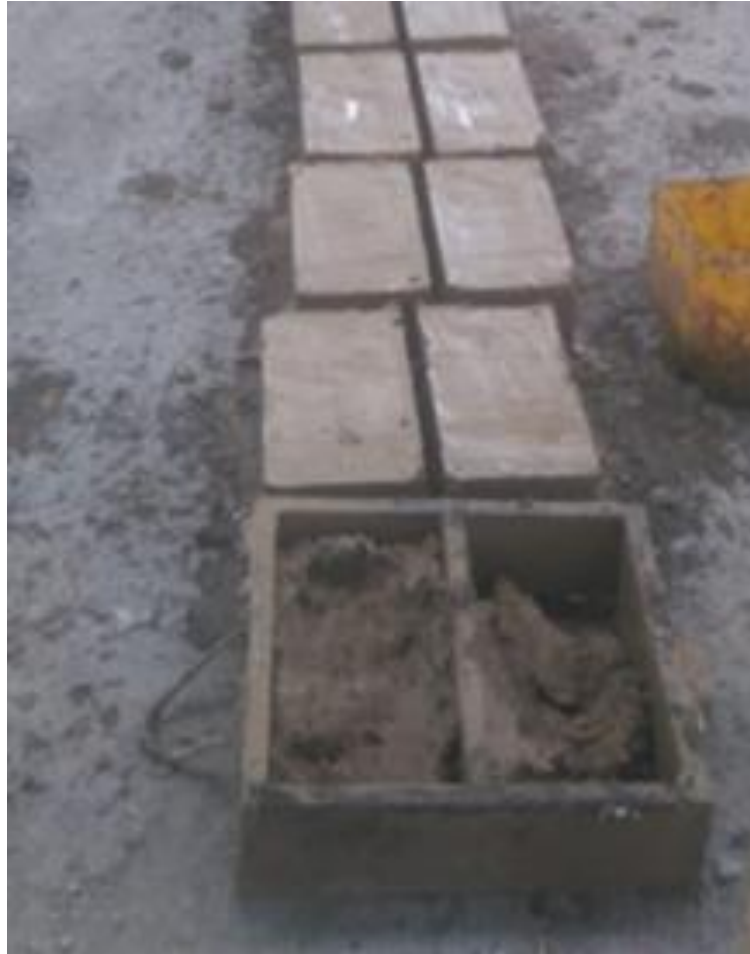
Figura 37 Moldeado. Mezcla final dentro de la gavera Elaboración propia.
