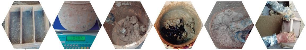
Figura 28 Proceso de elaboración. Preparación de mezcla para realizar el adobe Elaboración propia.
