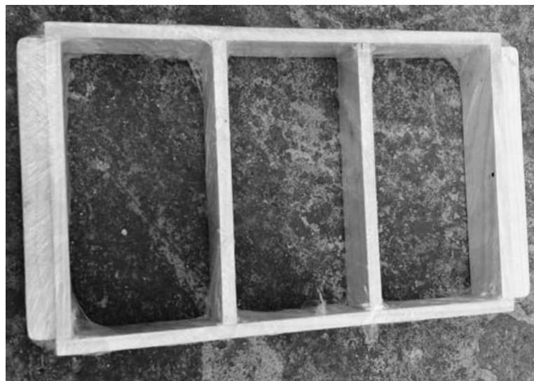
Figura 29. Elaboración de gavera. Se elabora gavera para tres moldes, para mayor producción. Elaboración propia.
