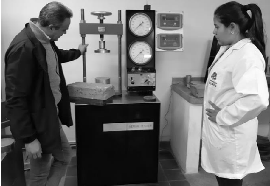
Figura 43 Compresión. colocación de platinas para el adobe. Elaboración propia.
