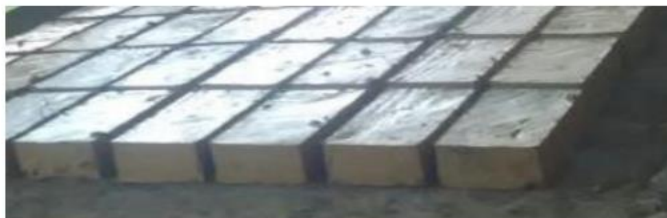
Figura 38 Secado del adobe. Secado de los adobes. Elaboración propia.
