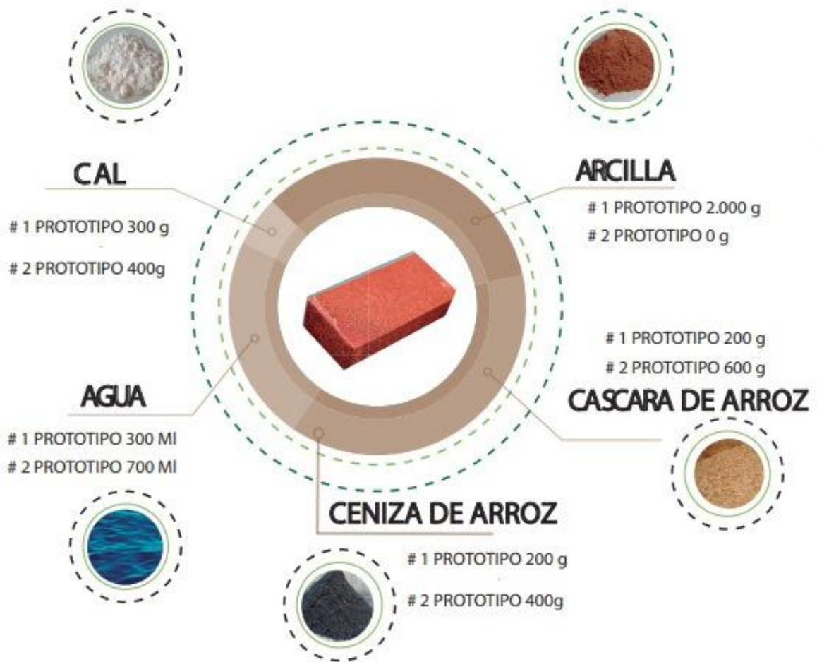
Figura 25 Porcentajes de materiales Elaboración del primer prototipo. Elaboración propia.
