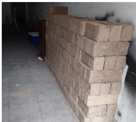
Figura 39 Producción final. Como se observa, se fabricaron 250 adobes, protegidos en bodega.
