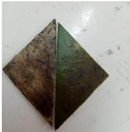
Figura 26. Comparación de piezas (derecha, sin residuos de pulpa) (izquierda, pieza con residuos de pulpa). Elaboración: Propia.
