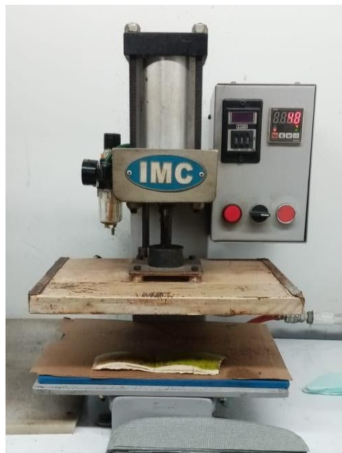
Figura 29. Máquina re-pujadora industrial. Elaboración: Propia.
