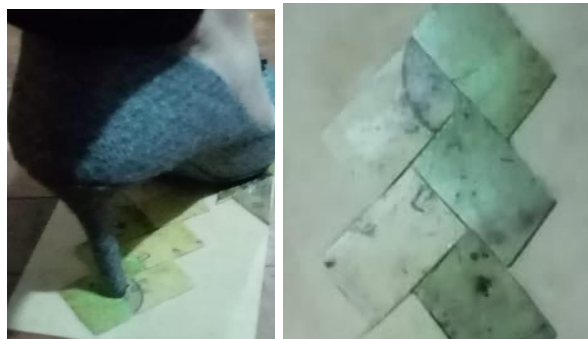
Figura 36. Prueba de Cargas punzantes. Elaboración: Propia.
