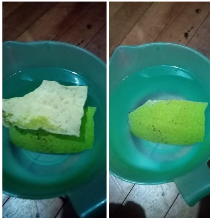
Figura 33. Prueba de absorción de agua. Elaboración: Propia.
