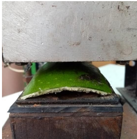
Figura 21. Re-pujadora con la primera pieza del fruto, aplica presión y calor al mismo tiempo. Elaboración: Propia.
