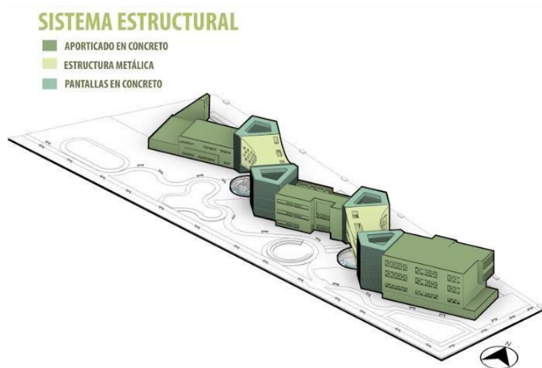
Figura 53 Sistemas estructurales en el equipamiento (planta cimentación) Fuente: Elaboración propia
