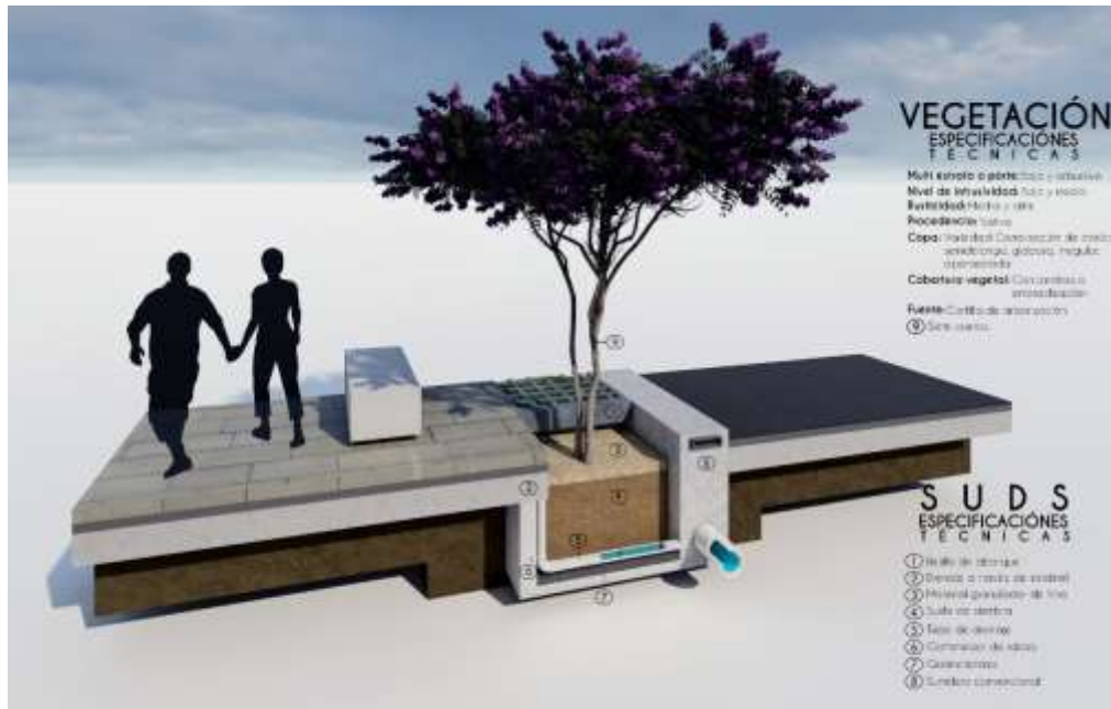
Figura 159: Detalle estructural SUBS Elaboración propia
