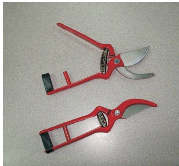
Tijeras de poda de 9 pulgadas, para poda de rebrotes y ramas bajas
