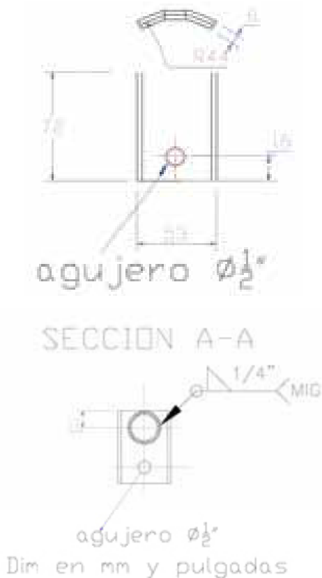
Gráfico 10.8 Planos y detalles de fijación de parales con radio de 44 mm.
