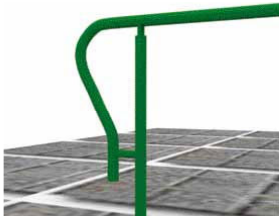
Gráfico 10.73 Detalles de remates y dobleces de baranda M-80.
