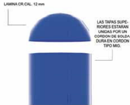
Gráfico 10.21 Detalle de tapas de parales.
