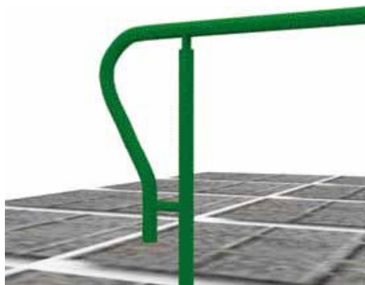
Gráfico 10.78 Detalles dobles y rodado de tubos
