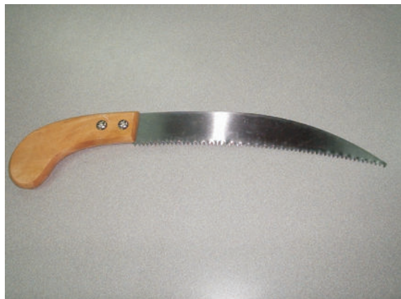
Serrucho de poda para ramas de diámetros cercanos a 1 pulgada
