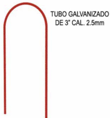
Gráfico 10.30 Tubo red est. de 3" cal 2.5 mm. galvanizado.
