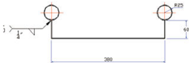
Gráfico 10.27 Detalle de soldado en filete.
