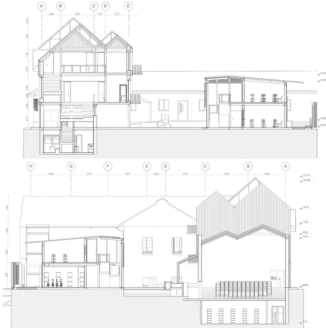
A14 CORTE TRANSVERSAL 5 ESC 1:100
