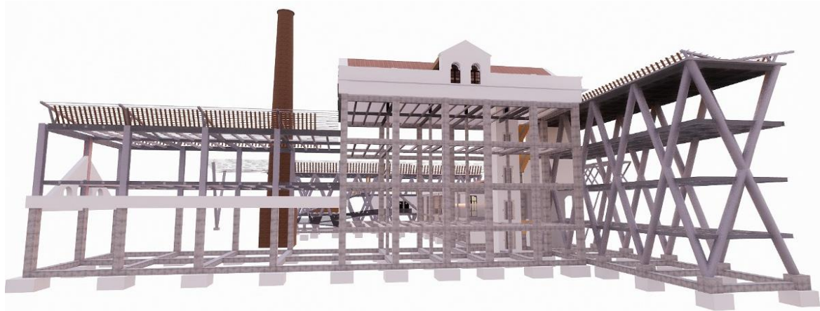
Figura 40. Sistema estructural 1, elaboración propia,2020
