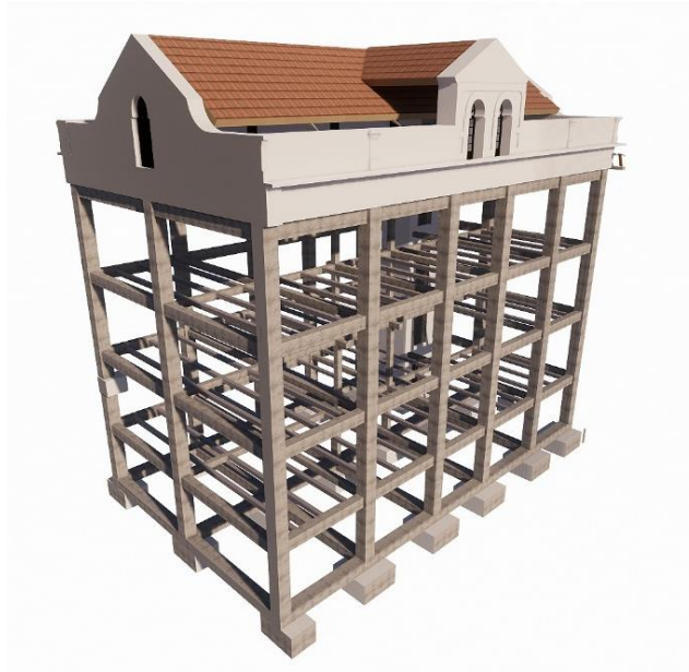
Figura 43. reforzamiento estructural 1, elaboración propia,2020.
