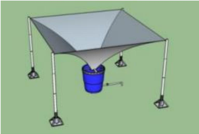
*Figura 36* Tipología de cubierta tensionada, Adaptado de “Sistema de reutilización de aguas en obra” Barón, Liévano y Rodríguez (2017), Recuperado de <https://bit.ly/2Tt6eLj>
