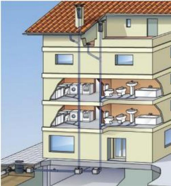
*Figura 20* Funcionamiento de sistema de bajantes, Tomada de “Evacuación Eficiente Cfgs Eficiencia Energética Y Energía Solar Térmica” (2016, p.16) Recuperado de [http://insilla.net/wp-content/uploads/2016/05/Evacuacion-Eficiente\\_P%C3%81GINAS.pdf](http://insilla.net/wp-content/uploads/2016/05/Evacuacion-Eficiente_P%C3%81GINAS.pdf)
