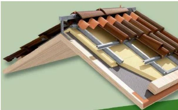
*Figura 6* Cubierta inclinada Tomada de Jornada técnica *Nueva arquitectura con cubiertas ventiladas de teja.* (13/09/2017). Recuperado de <https://bit.ly/3cR9pEm>
