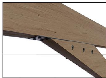
Figura 67: Detalle estructural anclaje en forma de T vigas de madera. Elaboración propia.
