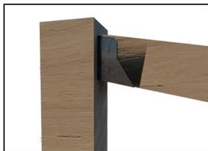
Figura 68: Detalle estructural, soportes de vigas de madera. Elaboración propia.
