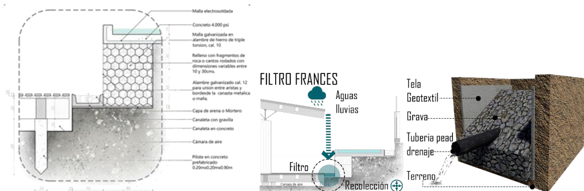
Figura 74: Detalle constructivo Zona de circulación. Elaboración propia.
