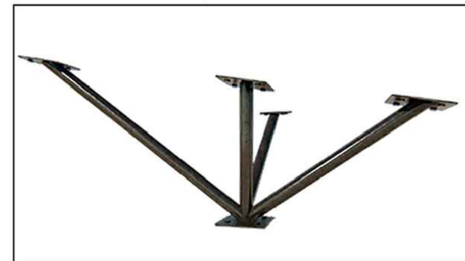
Apoyo metalico para cubierta con 4 barras de 0.05 long, 1 platina de 0.20m x 0.20m, 4 de 0.20m x 0.16 y tornillo tirafondo zinc 3/8pg x 4pg
