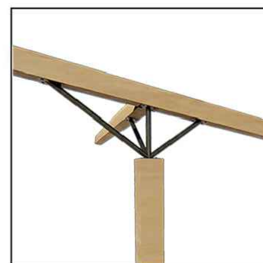
Detalle estructural con apoyo metalico en cubierta
