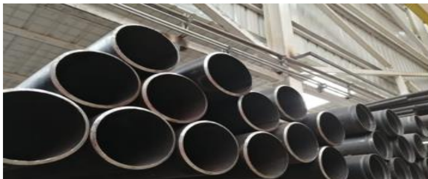
Figura 10 tubería a tratar diámetro 8 pulgadas acero negro. Elaboración propia (2020)
