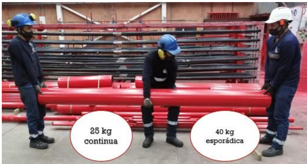
Figura 9 demostración de levantamiento de tubería del medio convencional, En este caso es un tubo de Ø8" de 3 metros de longitud. Con un peso aproximado de 125 kilogramos. Elaboracion propia (2020)
