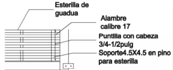
UNIÓN DE ESTERILLA A ESTRUCTURA ESC: 1:10
