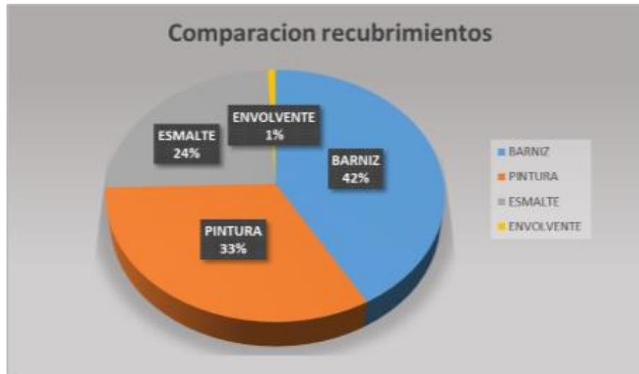
La grafica muestra una comparación entre los recubrimientos utilizados para la protección de tuberías de PVC, siendo el evolvente termoencogible mas rentable económicamente para la protección de las tuberías en PVC expuestas a la intemperie.
