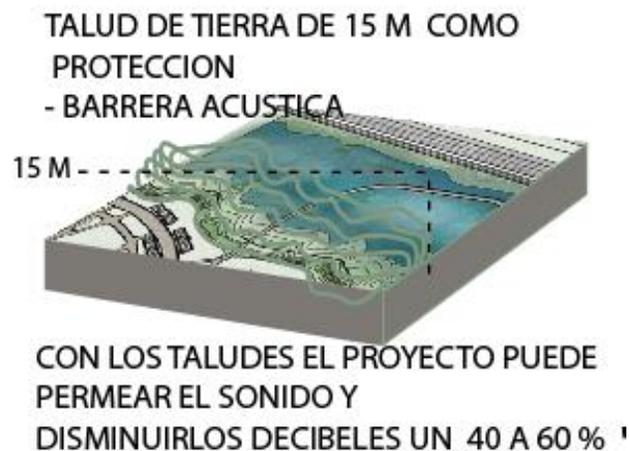
*Figura 53.* Talud natural - aislamiento del humedal. Fuente: Elaboración propia.
