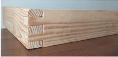
Se utiliza la unión en dado para los extremos de los módulos y del panel se utiliza pegamento de madera para fijar el ensamble
