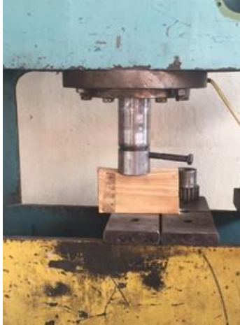
Figura 39. Ensayo a compresión en el canto resiste 30 Ton una sección 0.9x0.12. Elaboración propia.
