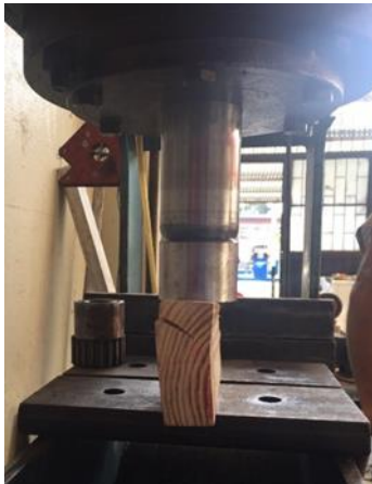
Figura 40. Ensayo a compresión en el canto resiste 30 Ton una sección 0.9x0.12. Elaboración propia.
