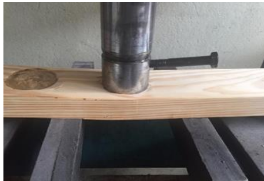
Figura 38. Ensayo 3 en \frac{1}{4} de pieza resiste a la tonelada, pero sufre un leve pandeo. Elaboración propia.
