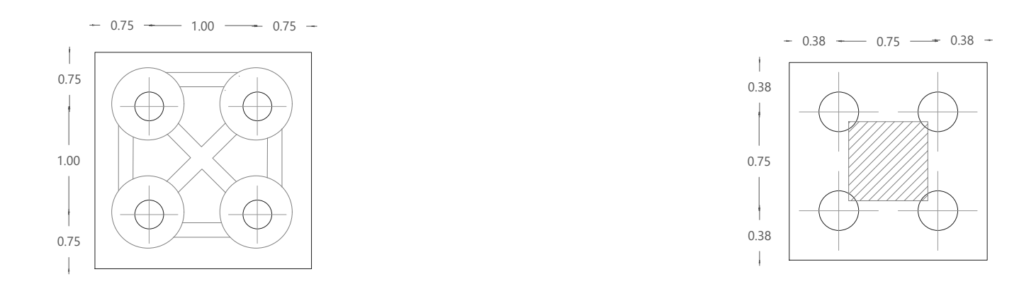
Detalle dado tipo 1 (D1) En cimentación de mega pórticos Detalle dado tipo 2 (D2) En cimentación de pórticos en concreto
