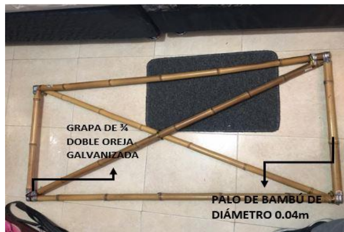
figura 22. Estructura de bambú panel modular, elaboración propia.
