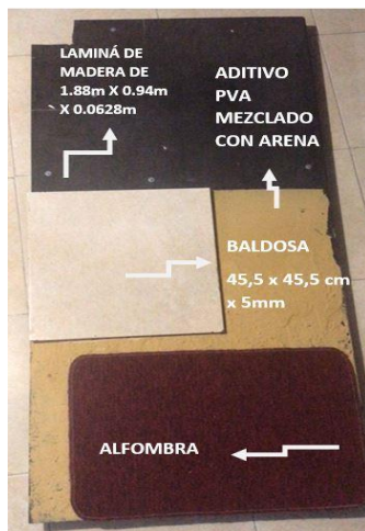
figura 42. Lamina de madera con aditivo y arena, elaboración propia
