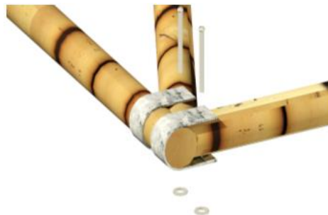
figura 27. Unión estructura en bambú con lamina esquinera, elaboración propia
