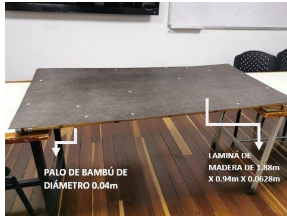
figura 30. Panel ensamblado en estructura de madera, elaboración propia
