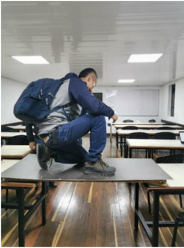
figura 35. Panel modular a prueba, elaboración propia
