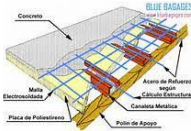
figura 6. Losa o placa en concreto (hormigón) reforzado. Refuerzo, barras de acero corrugada o malla metálica de acero. Tomado de http://rudyblogss.blogspot.com/2013/08/tipos-de-losas.html
