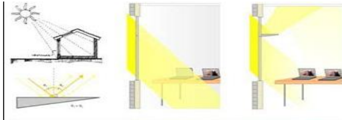
Figura 4. Incidencias Lumínicas en puestos de trabajo. Tomado de: Katrevich, 2002, p.1.
