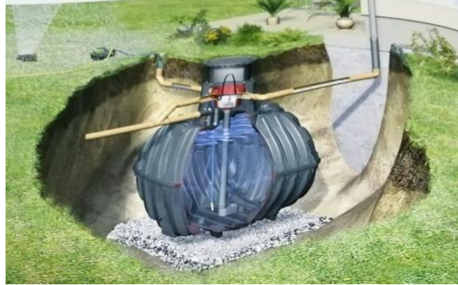
Figura 39: Funcionamiento tanque de agua.
