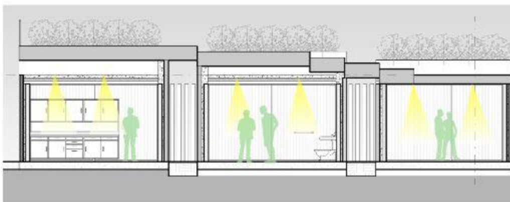
Figura 65. Iluminación de los espacios. Por medio de vanos en las cubiertas se ilumina de manera moderada el interior de los espacios. (Elaboración propia).
