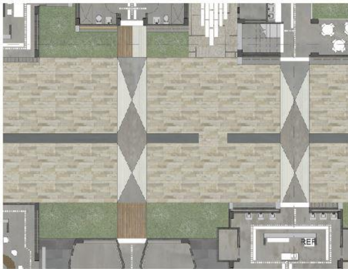
Figura 63. Alerta de acceso. Por medio de losas táctiles se crean diferentes texturas que indican el acceso a los espacios del proyecto. (Elaboración propia)
