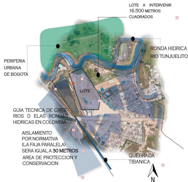
figura 20 Lugar de intervención A. adaptado de Google maps, imagen de la página principal y textos indicativos más sombreados., TRV 80 I No 93S, lugar de intervención análisis micro. Elaboración propia
