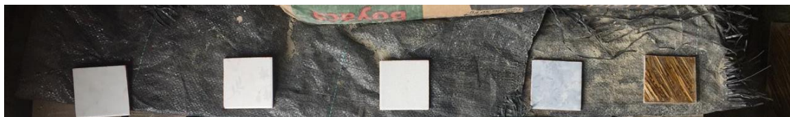
Figura 22 Probetas para prueba de impacto, las baldosas cerámicas se cortaron con una maquina cortadora y el azulejo a base de resina y guadua con pulidora angular, ya que su elasticidad no permitió los corten con máquina para cerámicos.
