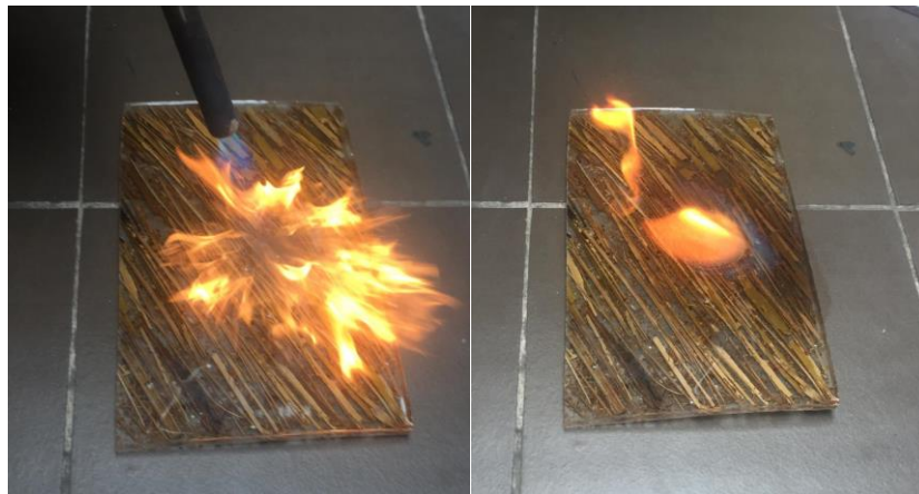
Figura 26 Ensayo de resistencia al fuego. Para el desarrollo del análisis se sometieron primero las baldosas cerámicas, observado el tiempo en segundos al realizarse su primera grieta. Elaboración propia.
