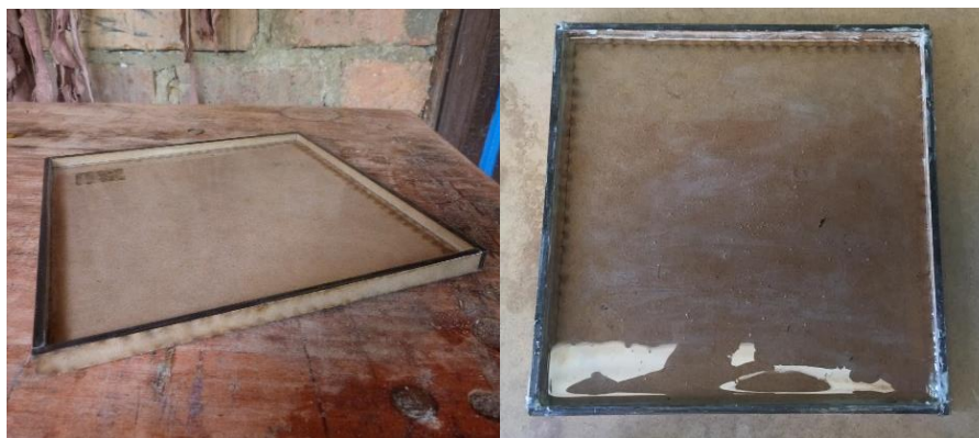
Figura 14 Molde elaborado en madera MDF Nota: Moldes cortados con maquina laser. Medida del molde (20X20). Es desarmable ya que se utilizó superbonder, en la parte de las juntas. Elaboración propia.
