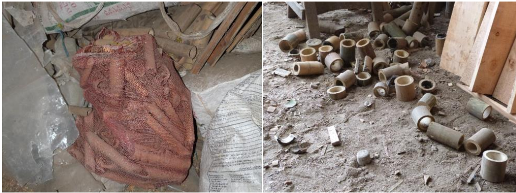
Figura 9 Agregados gruesos del alijado y desbastado de la guadua. Nota: algunos de estos elementos son utilizados por la empresa para fabricar distintas artesanías. Elaboración propia.
