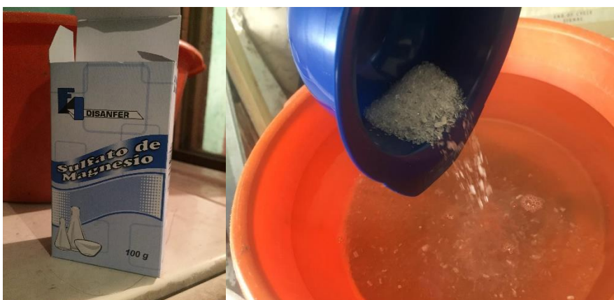
Figura 24 Dosificación de sulfato de sodio y agua. Para logra cubrir la totalidad de la baldosa en el recipiente utilizado se manejan 4 litros de agua y 160 de sulfato de magnesio, luego de esto se dejó reposar por 24horas. Elaboración propia.
