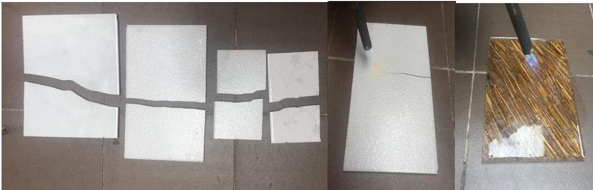
Figura 26 Ensayo de resistencia al fuego. Para el desarrollo del análisis se sometieron primero las baldosas cerámicas, observado el tiempo en segundos al realizarse su primera grieta. Elaboración propia.
