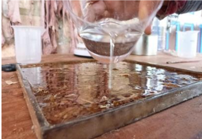
Figura 16 Aplicación de resina sobre el molde y residuos de guadua. Elaboración propia.
