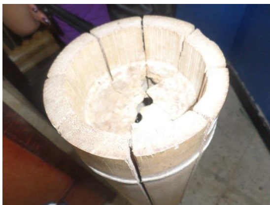
Figura 5 Corte de la guadua en tablillas, para la elaboración de pisos laminados, donde luego se prepara para el proceso de lijado y desbastado del material, procurando que todas las tablillas sean del mismo tamaño. Elaboración propia
