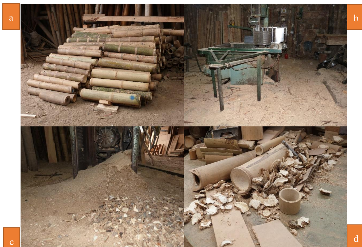
Figura 2: Residuos generados del proceso de fabricación de la guadua en la empresa arme ideas en guadua. a: desperdicio de guadua en agregados grandes. b: desperdicio de guadua en polvillo. c: desperdicio de guadua en astillado y polvillo. d: desperdicio de guadua en los coretes de boca de pescado y otras uniones. Elaboración propia.
