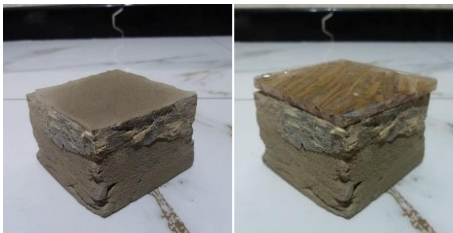
Figura 21 Capa de resina epoxica para ensayo de impacto. Placa en concreto de 75x75x50mm con capa de resina epoxica. Elaboración propia.
