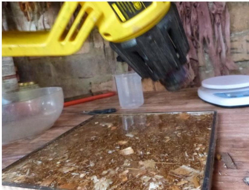
Figura 17 Secado con pistola de calor para evitar burbujas de aire. Elaboración propia
