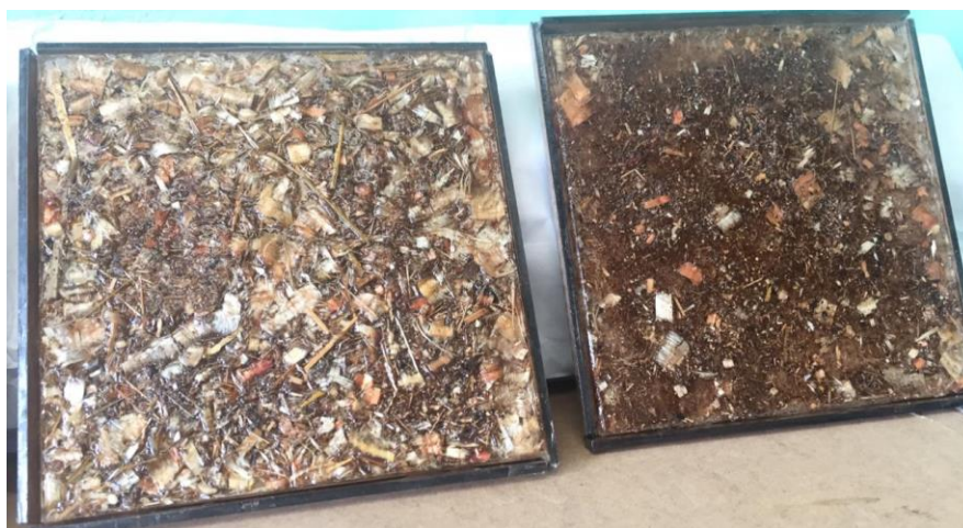
Figura 11 Probetas con resina poliéster. Nota: Al elaborar estas probetas se observó que el material no brillaba como se esperaba y no logró cubrir la totalidad de la baldosa, ya que luego de retirado el molde se encontraron huecos desfavorables y grietas que no lograban ser una ventaja como prototipo final. Elaboración propia.
