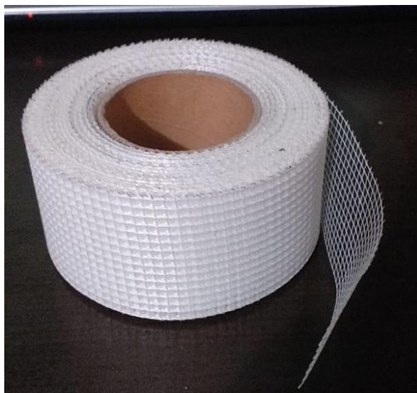
Figura 28 Malla de fibra de vidrio. Este material se coloca en la cara no lisa del azulejo de tal forma que el elemento este totalmente cubierta por ella. Elaboración propia.
