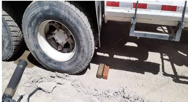
*Figura No. 37. Prueba adoquín rojo - T. Vehicular.*
