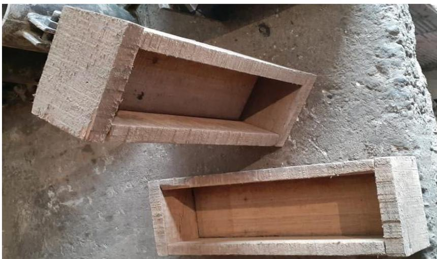
Figura No. 19. Molde para la producción de Adoquín Español.
