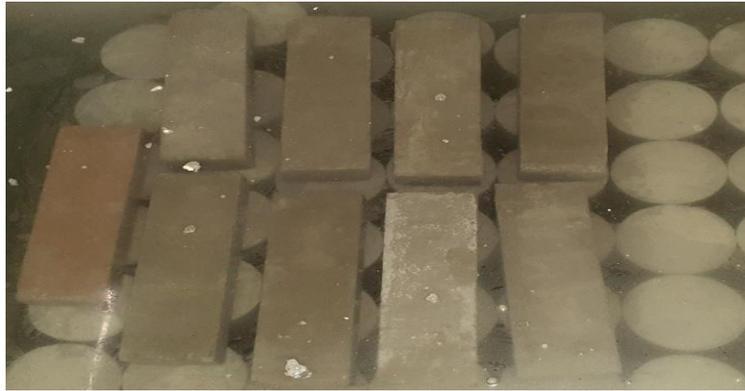
*Figura No. 36. Adoquín en curado.*
