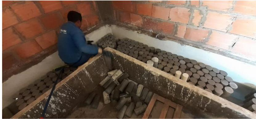
*Figura No. 22.* Cilindros para pruebas de concreto estructural.
