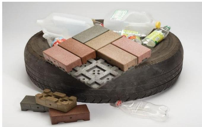
*Figura No. 4.* Elementos utilizados para la elaboración del bloques AZEK.
