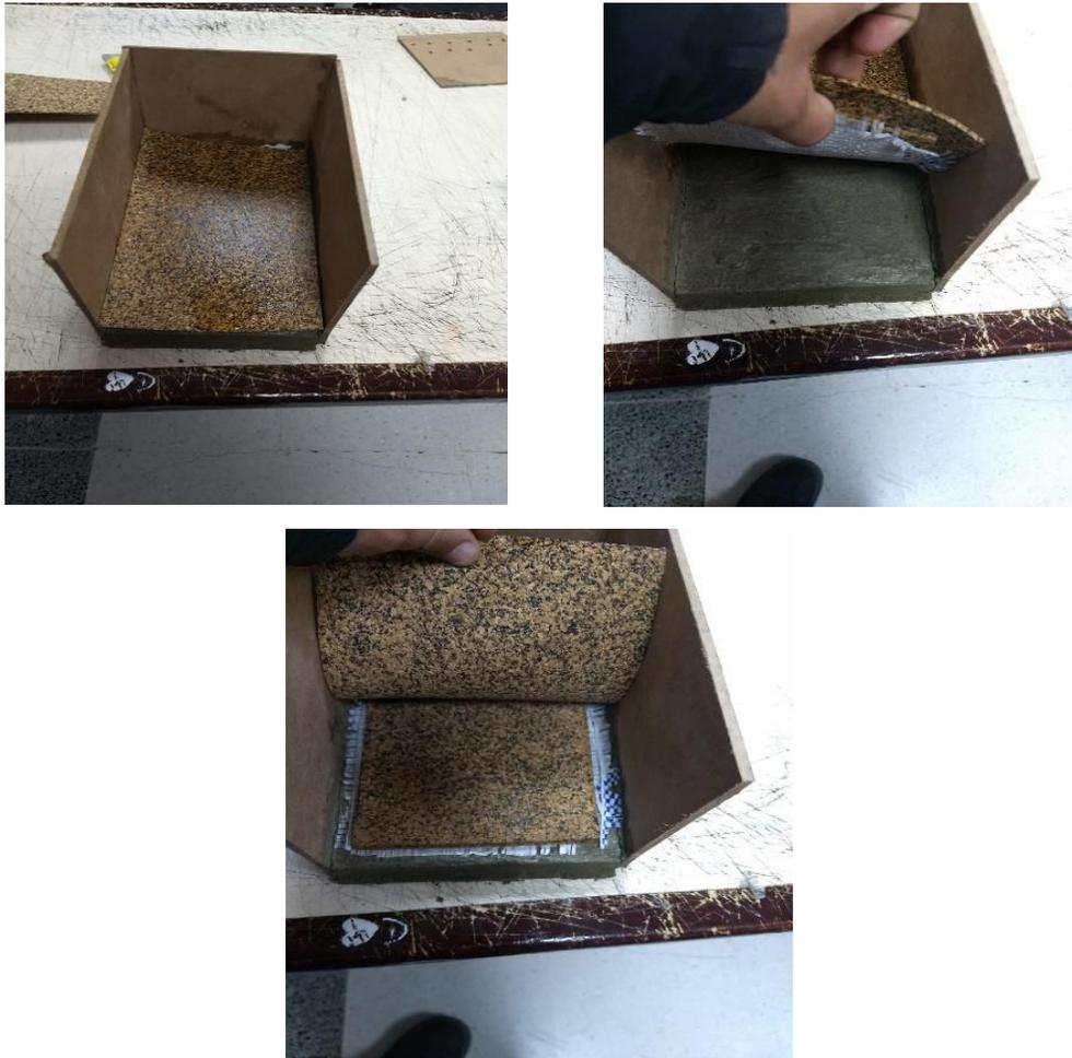
*Figura 27 Pruebas de filtración expone reacción del corcho ante el contacto al agua, elaboración propia*
