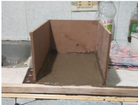
*Figura 22 Prototipo 3 se expone prototipo 3 cubierta plana con afinado concreto impermeable 5cm espesor, elaboración propia*
