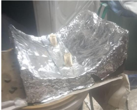
*Figura 21 Prototipo 2 se expone prototipo 2 diseño en v con capa impermeable en aluminio, elaboracion propia*
