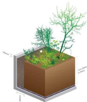
*Figura 5 Cubierta intensiva Implementación de cubierta intensiva comparable con un jardín en cubierta por Abellán (2013) Recuperado de <http://sudsostenible.com/tipos-de-cubiertas-verdes/>*
