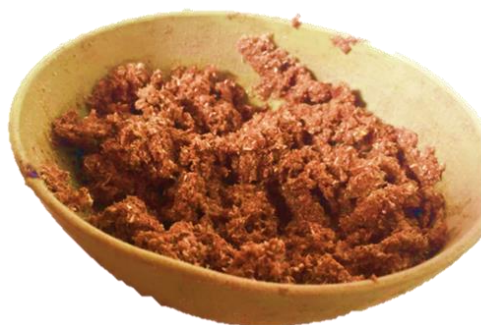
Figura 15: Aglomerado con cola para madera, aserrín de madera y retazos de papel. Elaboración propia.
