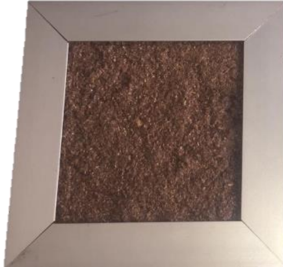
Figura 16: Prototipo de cola para madera, aserrín de madera y retazos de papel. Elaboración propia.
