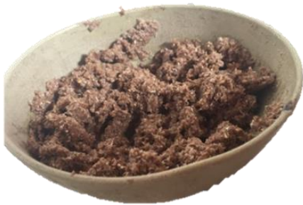
Figura 9: Aglomerado de agua con harina de trigo y aserrín de madera. Elaboración propia.
