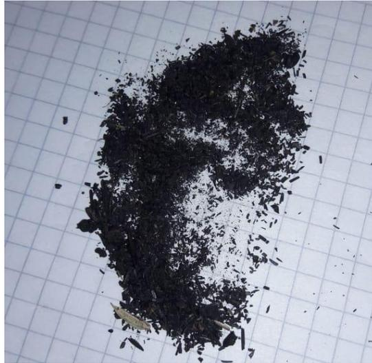
*Figura 40* Resultado de la quema de la cascarilla. Elaboración propia
