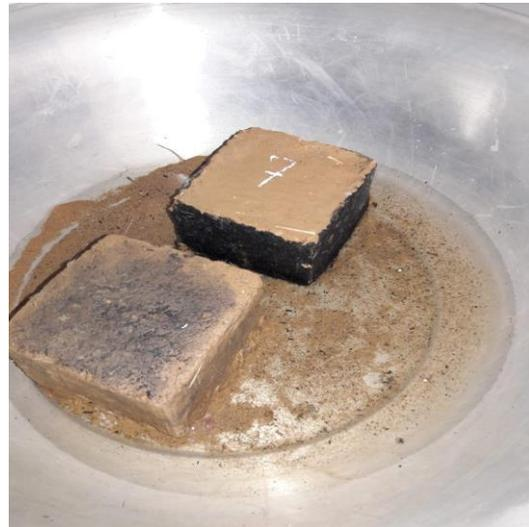
Figura 68 y Figura 69 Inmersión de los prototipos con impermeabilizante en diferentes dosificaciones. Elaboración propia
