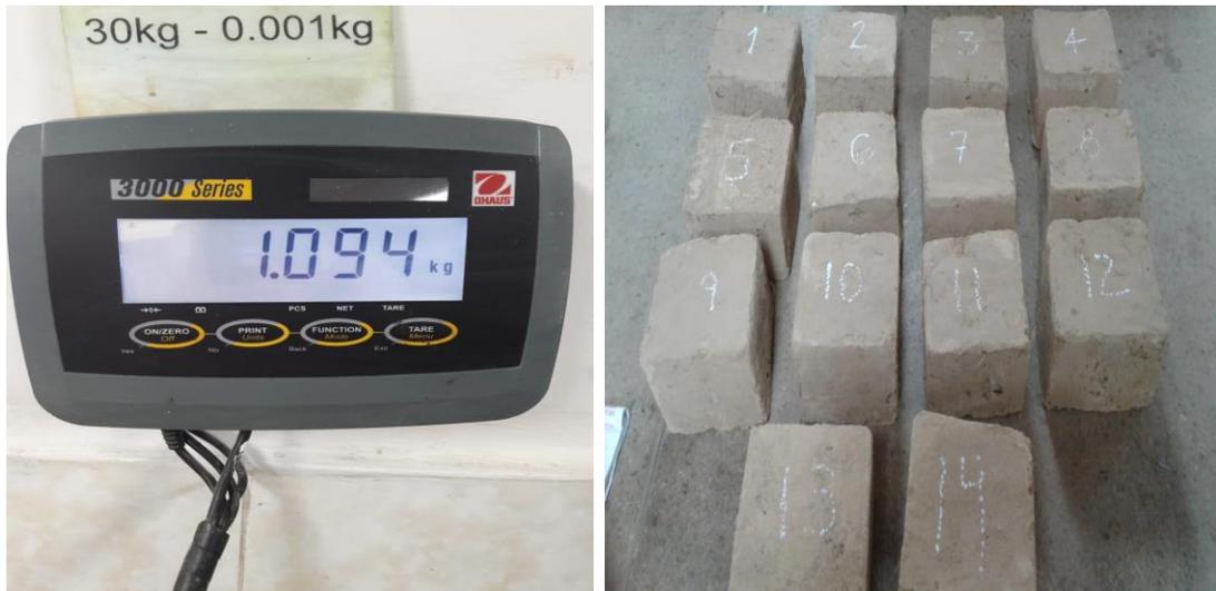
Figura 58 y Figura 59 Toma de pesajes de los prototipos y muretes después del secado. Elaboración propia
