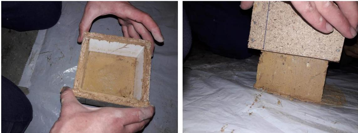
*Figura 32 y Figura 33* Desmolde de los prototipos. Elaboración propia
