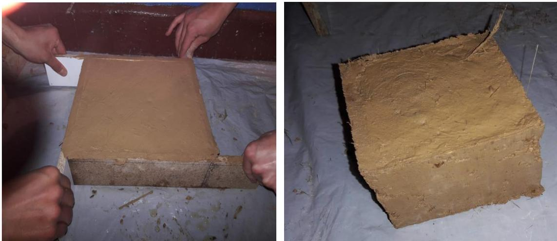
*Figura 34* Desmolde del murete y prototipos desmoldado. Elaboración propia
