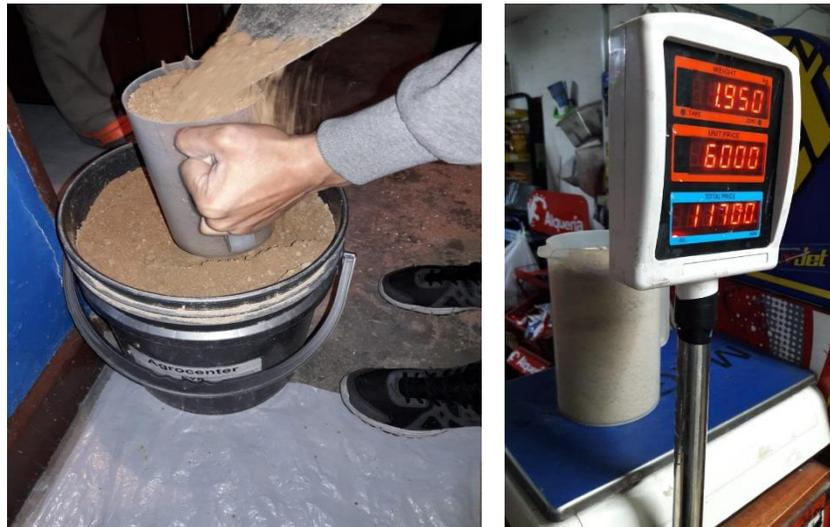
Figura 21 y Figura 22 Adición de tierra al recipiente y peso del material. Elaboración propia
