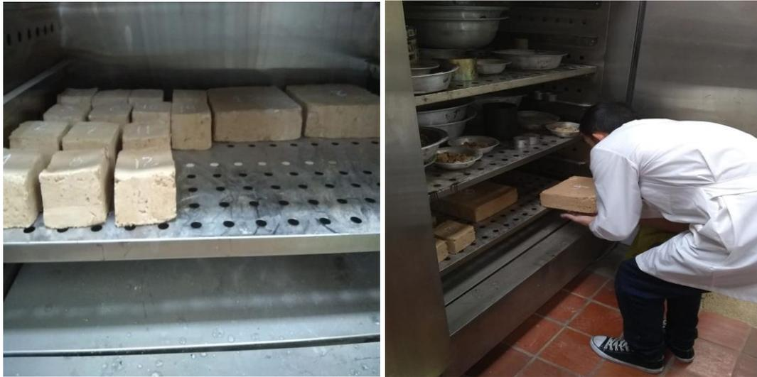
*Figura 54 y Figura 55* Colocación de los prototipos y muretes en el horno. Elaboración propia
