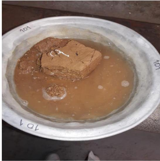
*Figura 70* Prototipo sin impermeabilizar después de la prueba de inmersión. Elaboración propia
