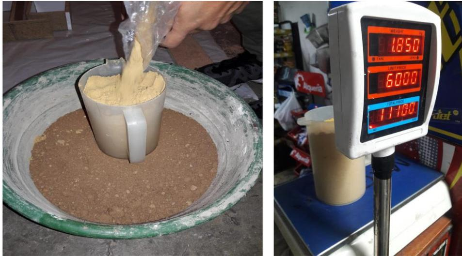
*Figura 23 y Figura 24 Adición de arena al recipiente y peso del material. Elaboración propia*
