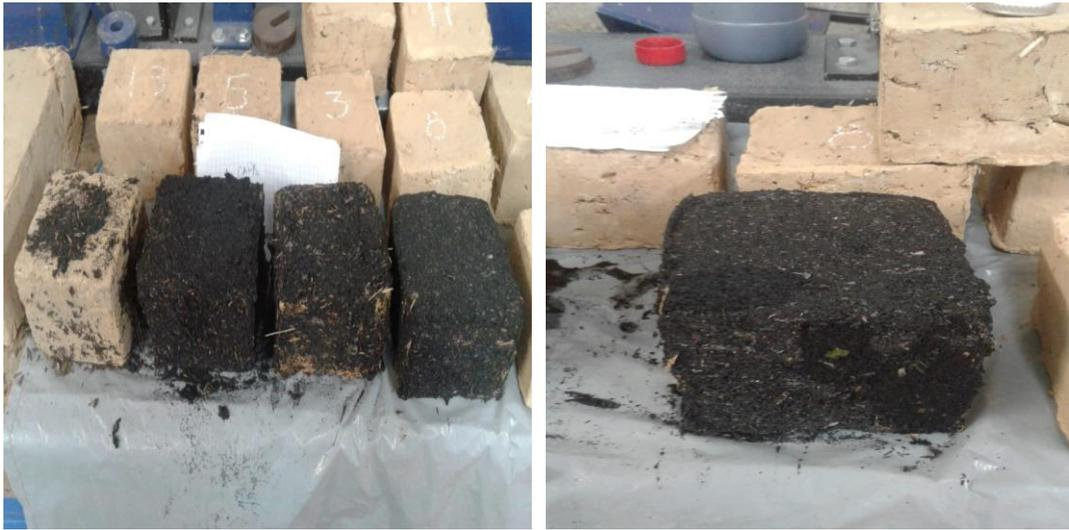
*Figura 65 y Figura 66* Aplicación de los impermeabilizantes tipo A, B, C, D. Elaboración propia
