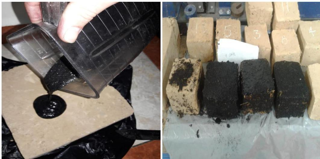
Figura 63 y Figura 64 Aplicación de la mezcla impermeabilizante con las dosificaciones A, B, C y D. Elaboración propia
