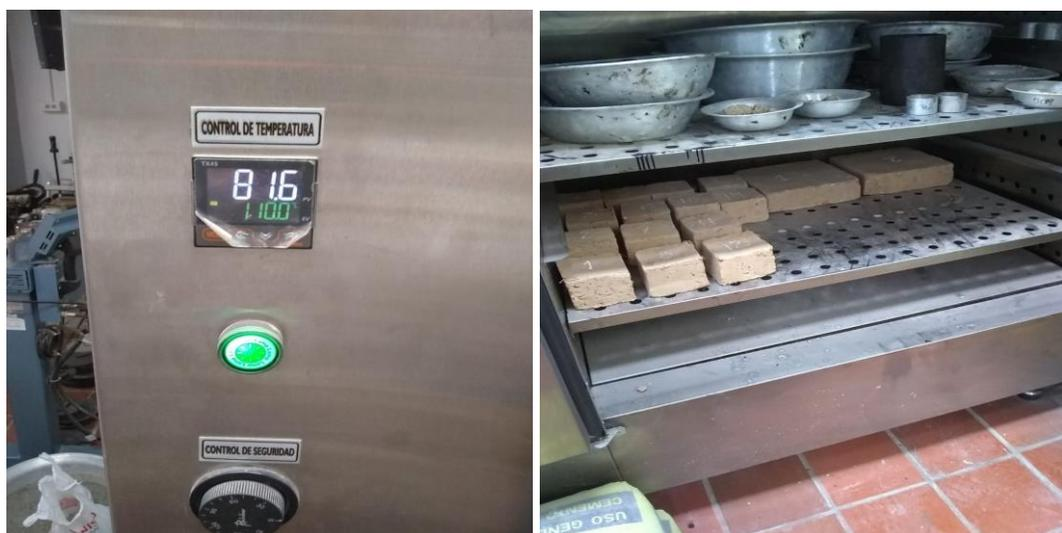
*Figura 56 y Figura 57* Retiro de los muretes y prototipos del horno. Elaboración propia
