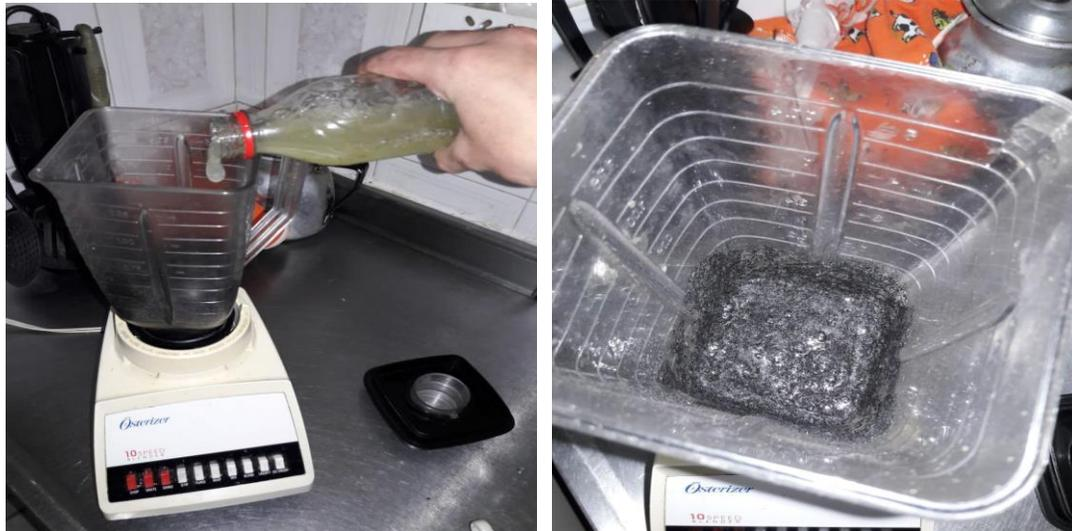
Figura 46 y Figura 47 Licuado de la ceniza con sábila. Elaboración propia
