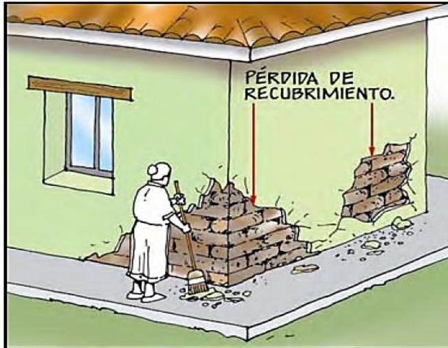
*Figura 8* Pérdida de recubrimiento en muros. Tomado de Manual para la rehabilitación de viviendas construidas en adobe y tapia pisada
