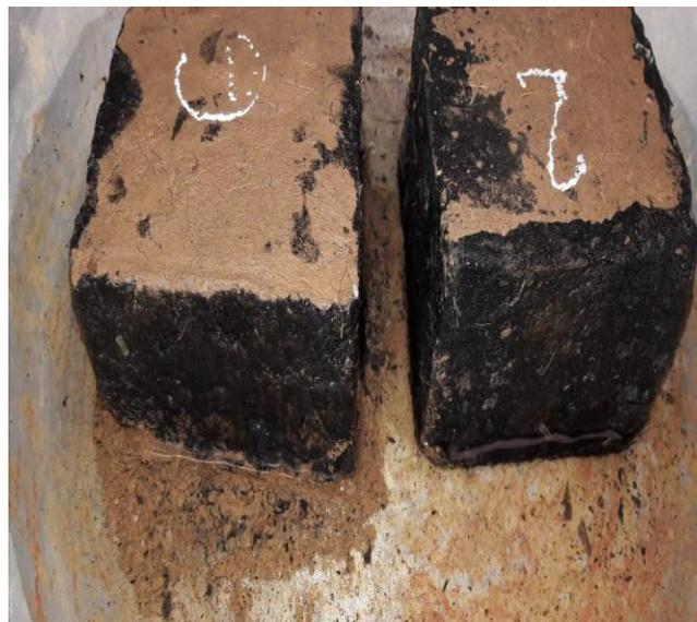
*Figura 71* Prototipos impermeabilizados después de la prueba de inmersión. Elaboración propia
