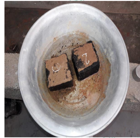
Prototipos con mezcla de ceniza y sábila (2 dosificaciones)
