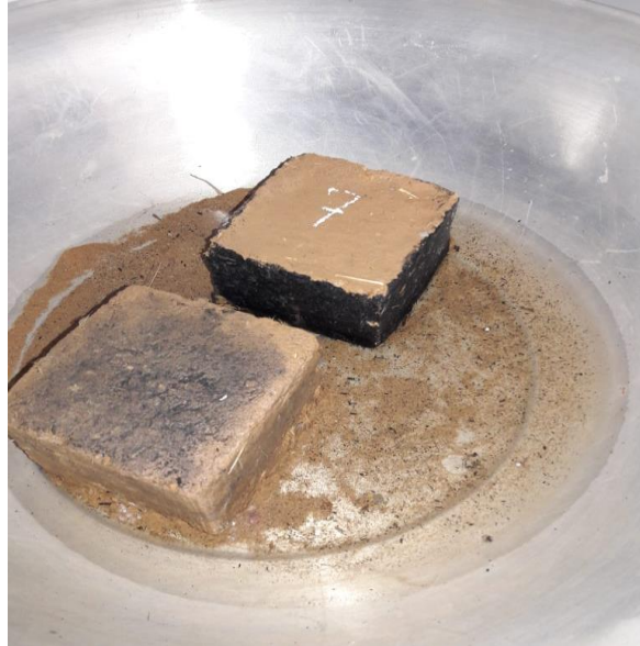
Prototipos con mezcla de ceniza con agua y otro con sábila
