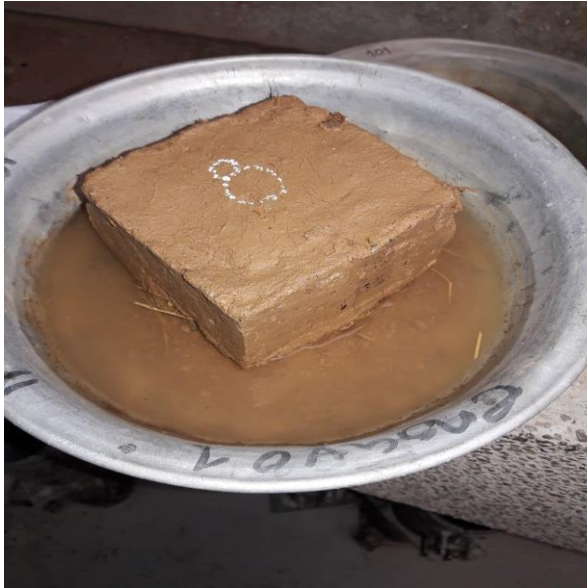
Prototipo sin impermeabilizar
