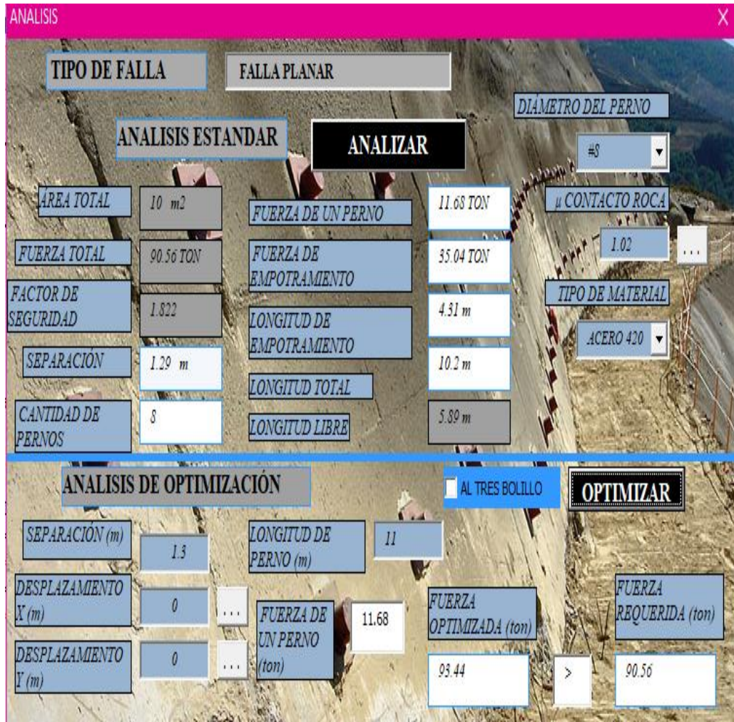
FIGURA 23 Resultados análisis estándar del ejercicio por falla planar con patrón normal.
