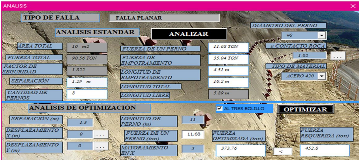
FIGURA 32 Resultados análisis estándar del ejercicio por falla planar con patrón al tres bolillo.
