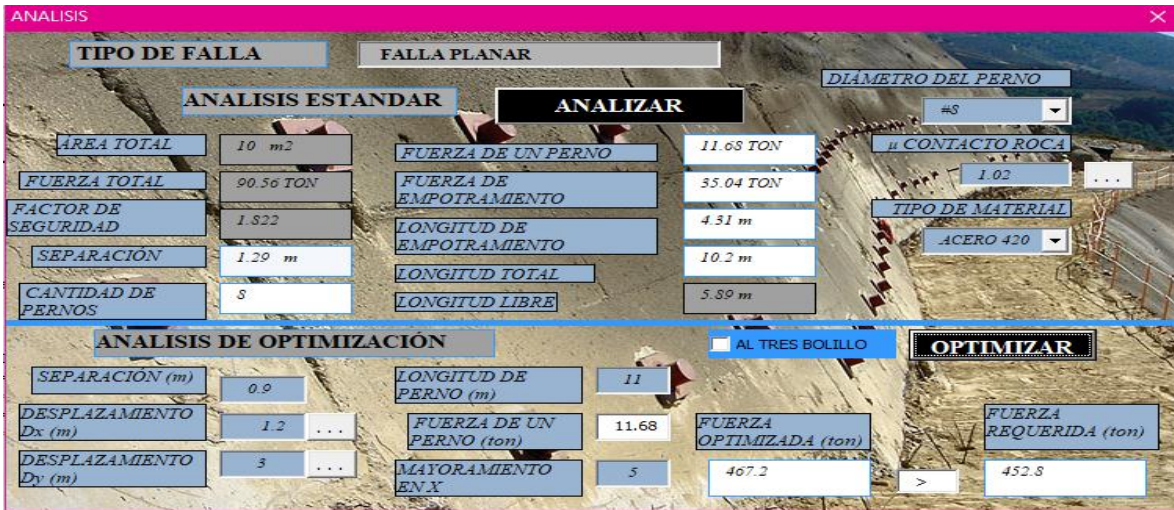
FIGURA 36 Resultados análisis estándar del ejercicio por falla planar con patrón normal.
