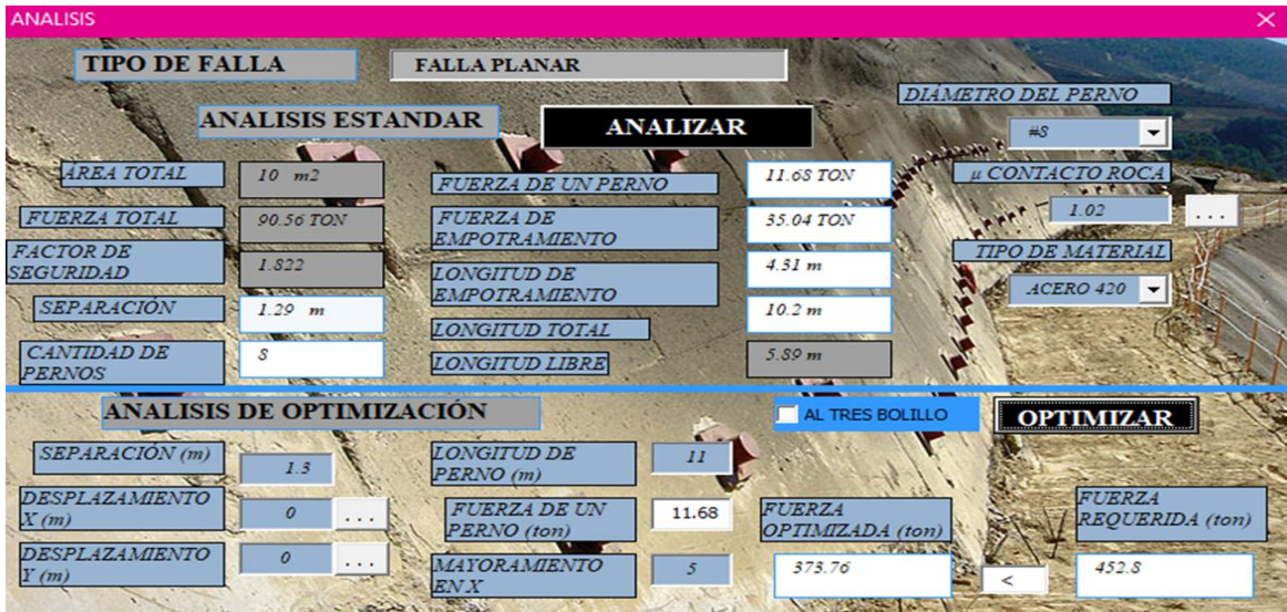
FIGURA 28 Resultados análisis estándar del ejercicio por falla planar con patrón normal con una separación de 1.3 metros.
