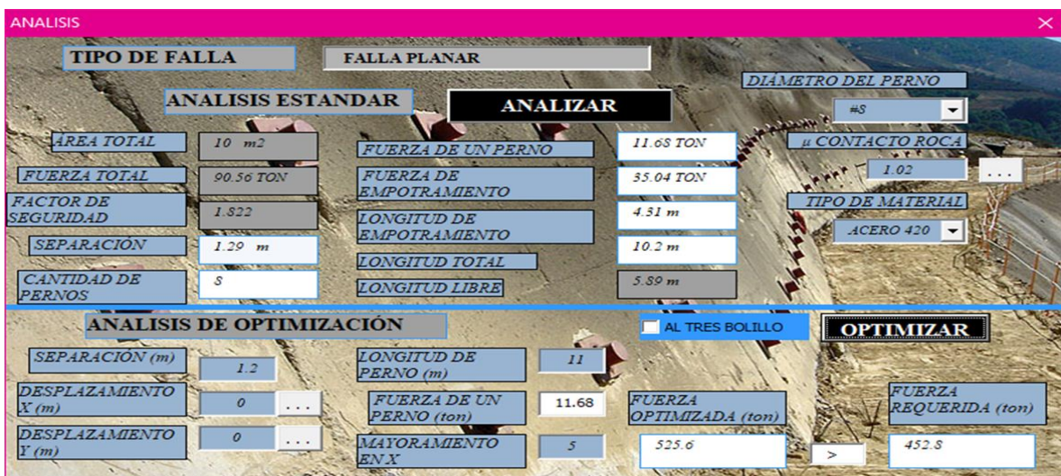
FIGURA 29 Resultados análisis estándar del ejercicio por falla planar con patrón normal con una separación de 1.2 metros.
