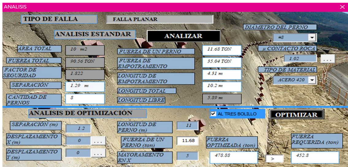
FIGURA 33 Resultados análisis estándar del ejercicio por falla planar con patrón al tres bolillo.
