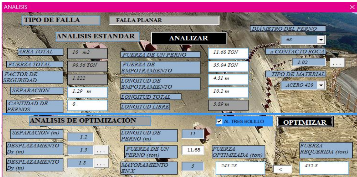
FIGURA 39 Resultados análisis estándar del ejercicio por falla planar con patrón al tres bolillo con separación 1.3 metros.
