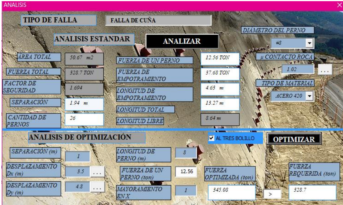
FIGURA 54 Resultados análisis optimizado del ejercicio de falla por cuña con patrón tres bolillo
