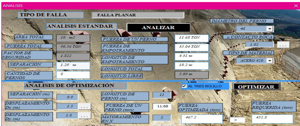
FIGURA 40 Resultados análisis estándar del ejercicio por falla planar con patrón al tres bolillo con separación de 0.9 metros
