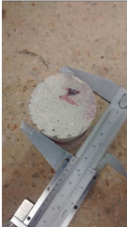
Figura 19. Diámetro del núcleo
