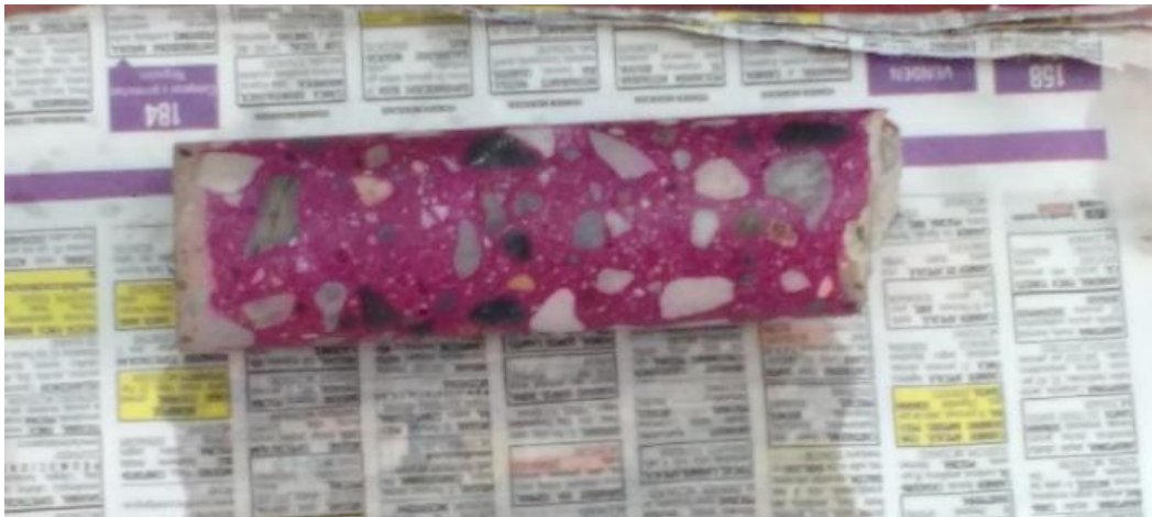
Figura 11. Carbonatación en núcleo
