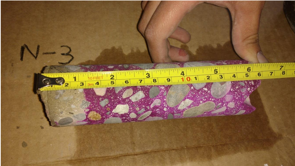
Figura 21. Ensayo de profundidad de carbonatación en el núcleo No 3.
