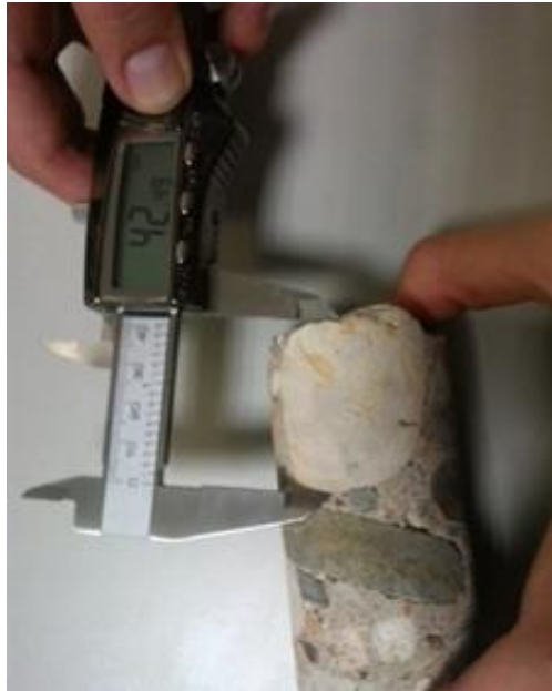
Figura 20. Tamaño de los agregados en las muestras extraídas.
