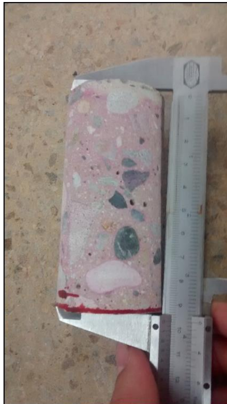
Figura 18. Longitud del núcleo
