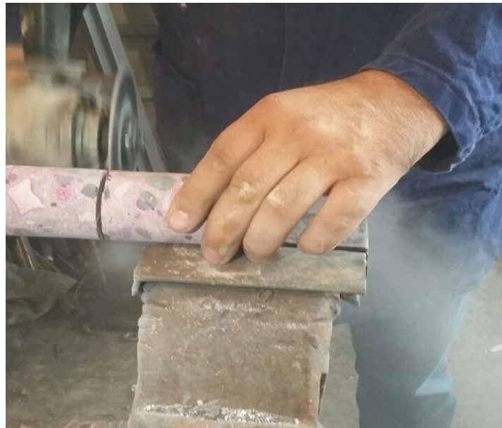
Figura 16. Corte del núcleo
