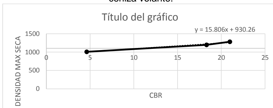
Grafico 23 Comportamiento de CBR vs densidad máxima seca para 40% de ceniza volante.
