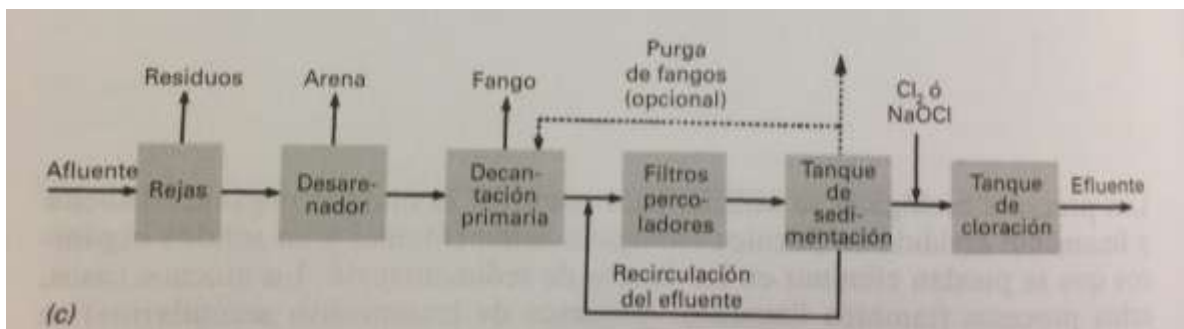
Figura 28. Diagrama de flujo típicos simplificados para los procesos biológicos utilizados en el tratamiento de aguas residuales
