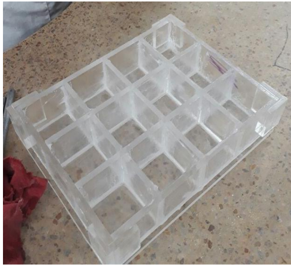
Figura 18. Moldes para las probetas.
