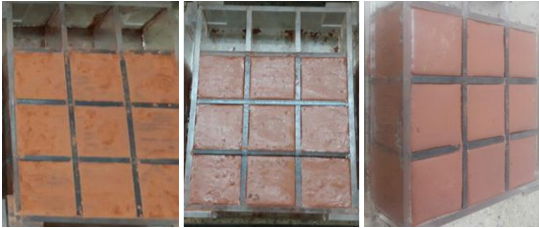
Figura 22. Geopolímero a 3, 7 y 28 días de curado respectivamente
