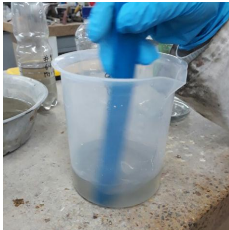
Figura 16. Mezcla de activadores alcalinos
