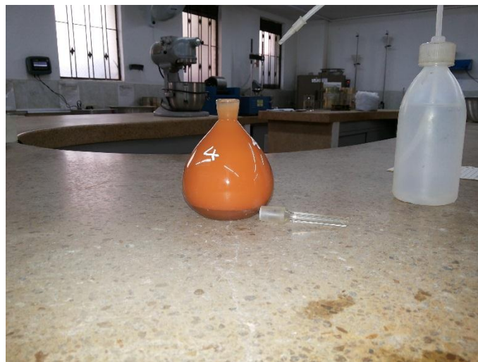
Figura 10. Ensayo de gravedad específica
