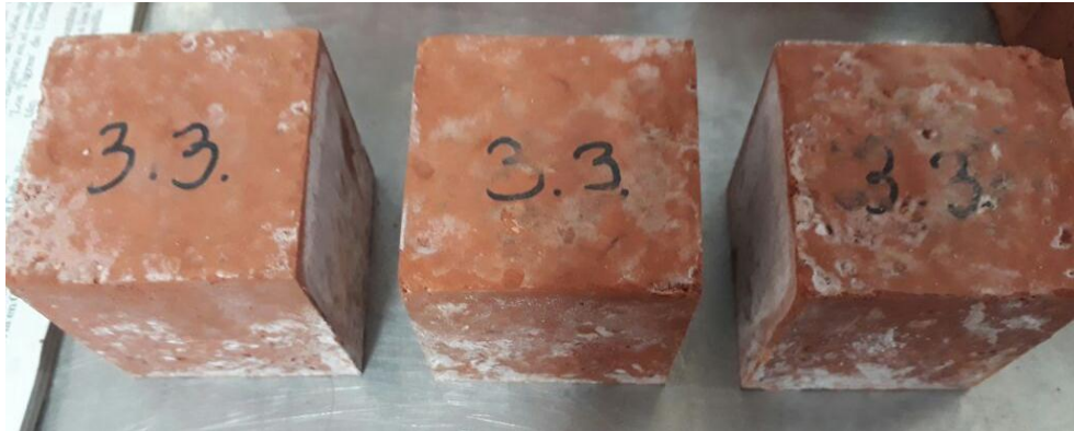
Figura 29. Proceso de carbonatación en probetas de geopolímero
