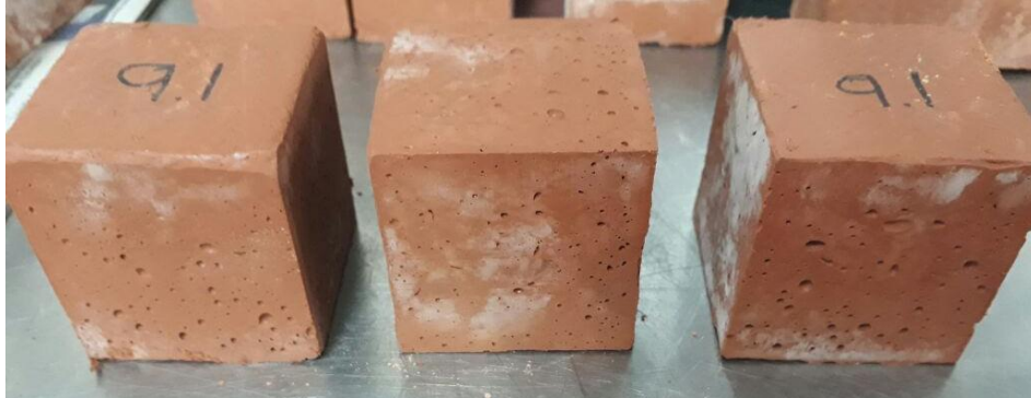
Figura 27. Porosidad en las probetas de geopolímero
