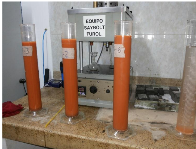
Figura 11. Ensayo de granulometría por hidrómetro
